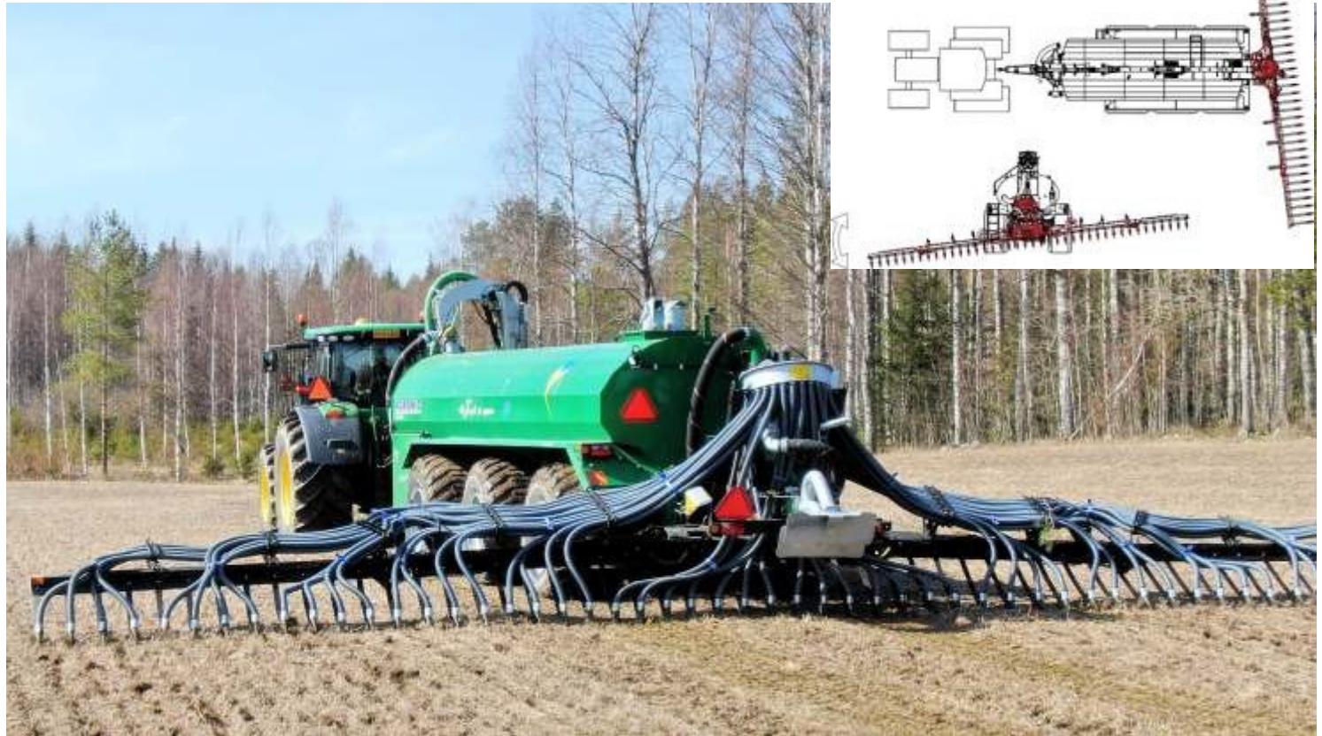
Система компактно складывается для транспортировки, боковые секции сворачиваются автоматически.
