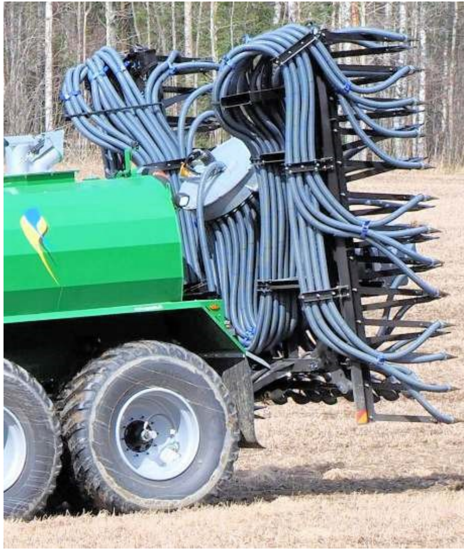
Система компактно складывается для транспортировки, боковые секции сворачиваются автоматически.
