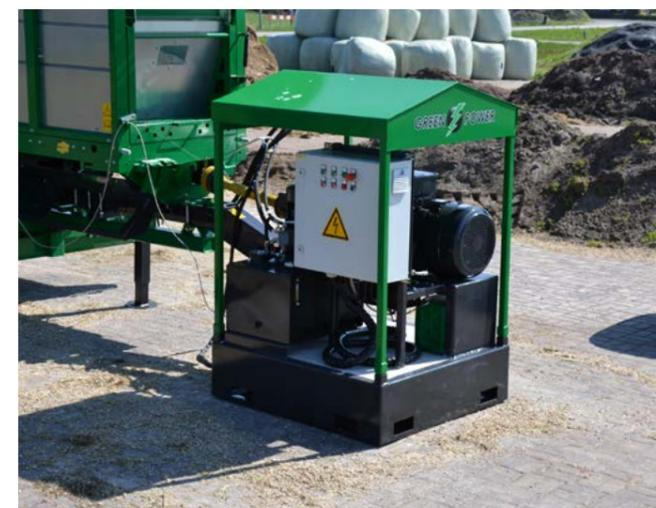
AGRONIC MultiBaler 820 может работать также и от электромотора «AGRONIC Electro Powerpack». Это идеальное решение для стационарного использования на хозяйстве, ферме, монокормовом заводе и т.д.
