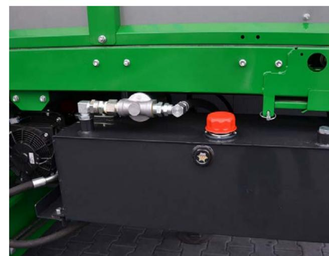
AGRONIC MultiBalers уже в базовой комплектации оснащаются собственной гидравлической системой на основе двух масляных насосов.
