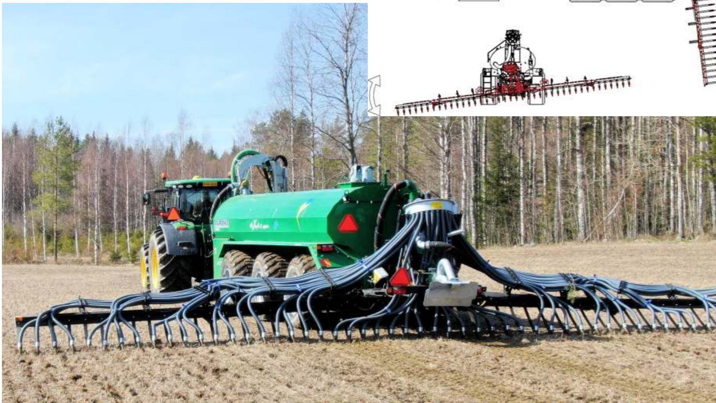
Kuljetusasento on kompakti, siipien taitto on automatisoitu.
