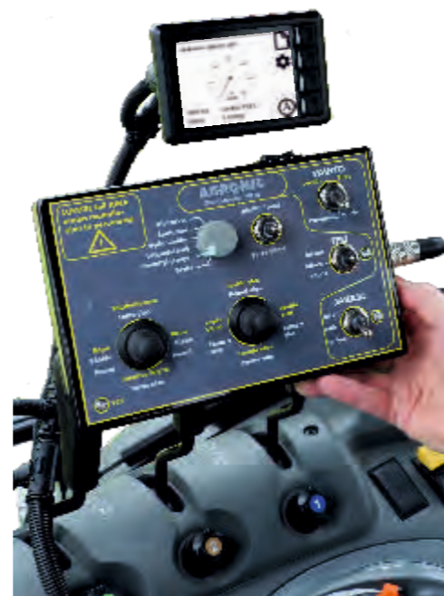
Agronic U- Control 3,5" näytöllä U- Controlin avulla telinlukitusrutiinit hoituvat automaattisesti, toteutuneet kuormat, kuutiot ja pinta-alat tallentuvat nimettäville muistipaikoille.
