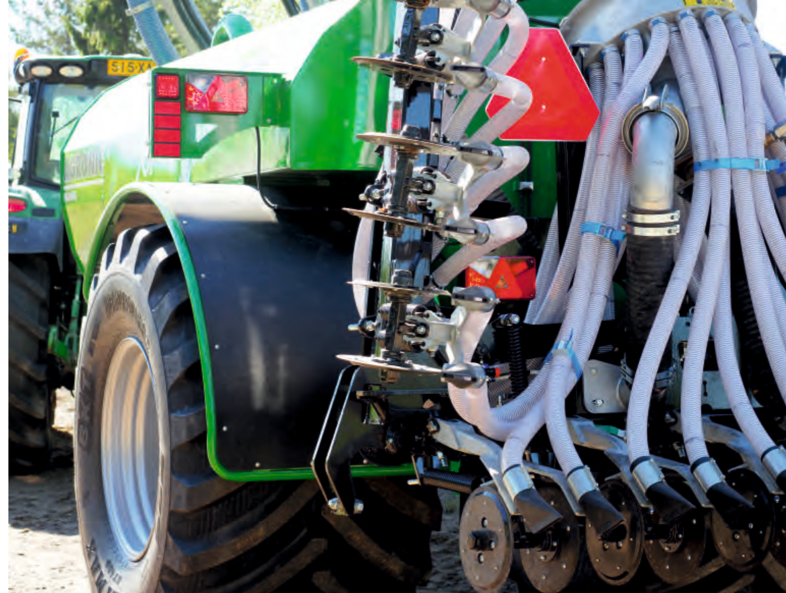
1050/50R32 radialdäck, strålkastare och stänkskärmar som standard.
