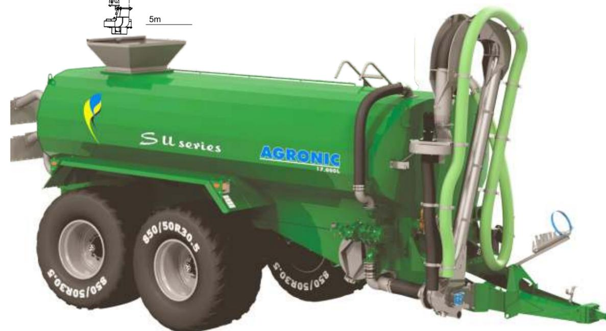
Des pompes autoamorçantes peuvent être offertes pour tous les modèles de tonnes à lisier et de bras de pompage. La tonne sera rempli par une pompe à lobes avec une turbine en caoutchouc jusqu'à ce que les tuyaux soient pleins. Une fois les tuyaux remplis, le processus de remplissage sera ensuite géré avec la pompe du bras de chargement.
