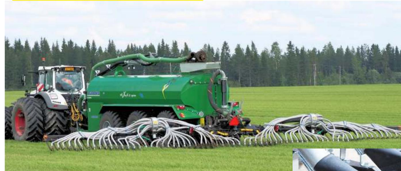
Le TSR12000 est disponible avec deux distributeurs de type excentrique de Harsø au Danemark. Cela permet de réduire de moitié la largeur de travail, de raccourcir les flexibles d'alimentation et de réduire l'espacement des rangs.
