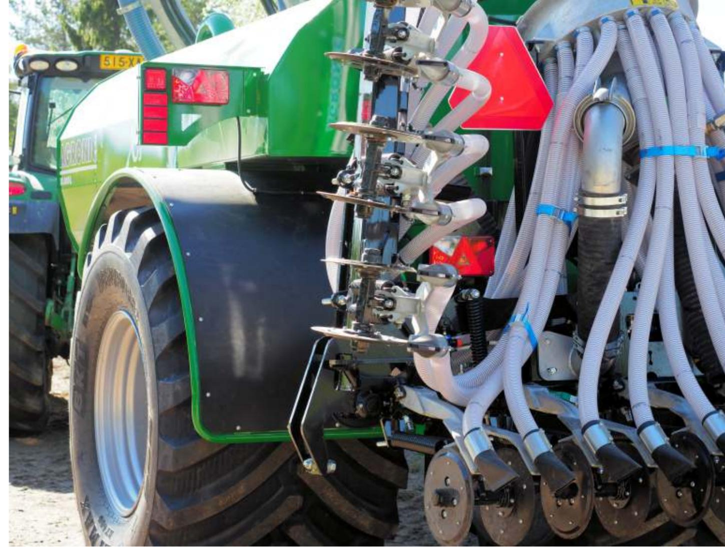
Pneus radiaux 1050/50R32, l'éclairage LED et ailes en équipement standard.
