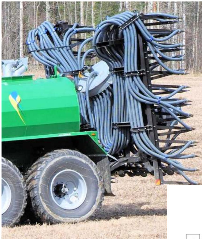
Les rampes à sabots AGRONIC permettent d'appliquer le lisier là où il offre le plus d'avantages : directement sur les racines des plantes, pendant la saison de croissance. Avec une perte de nutriments réduite et des odeurs réduites.
