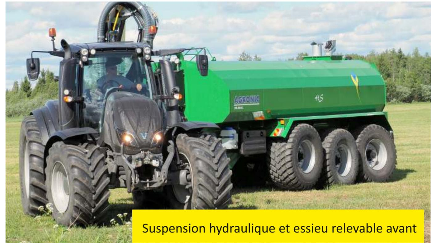
La photo montre une tonne à lisier équipée de pneus de route pour le transport. Grâce au centre de gravité bas de la tonne à lisier, une répartition correcte du poids et un transport par suspension hydraulique peuvent être réalisés en douceur à des vitesses plus élevées. Sur les versions à essieu tridem, un essieu relevable avant est un équipement standard.
