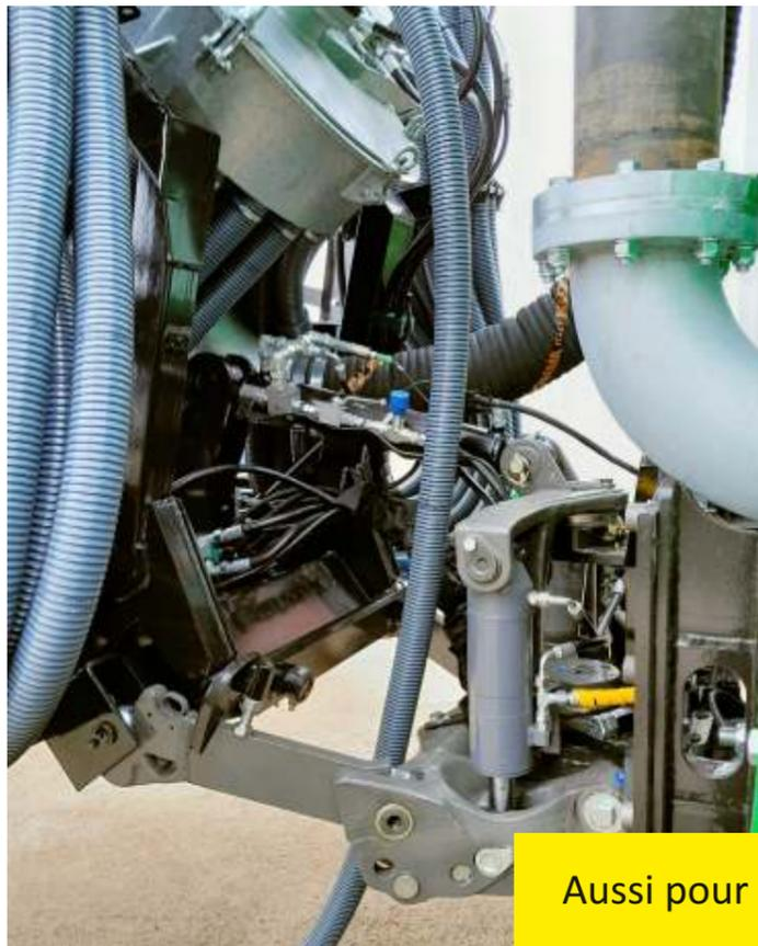
Accessoire pivotant unique, la rampe d'épandage peut être dirigée avec la tonne à lisier.
