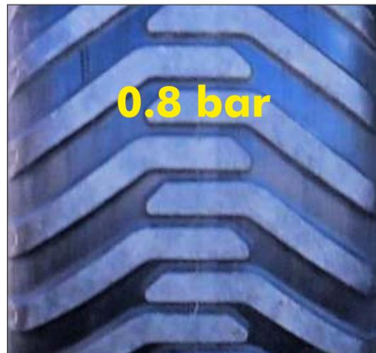
Contact de surface de roue de 0,8 bar (11,6 PSI) pour une largeur de 750 mm (29½ po) et une longueur de sculpture de 700 mm (27½ po). Pour 6 roues, la surface totale de contact est de 3,15 m<sup>2</sup> (34 pi<sup>2</sup>).
