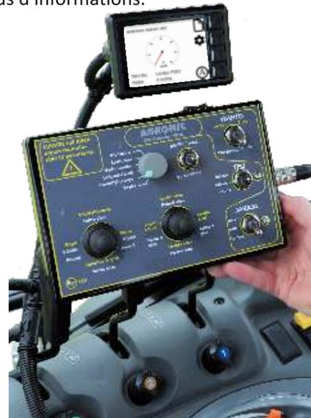
**Agronic U-Control** avec un écran de 3,5 pouces gère les routines de verrouillage, les charges et la quantité. la propagation et la surface couverte sont stockées dans des emplacements mémoire étiquetés.
