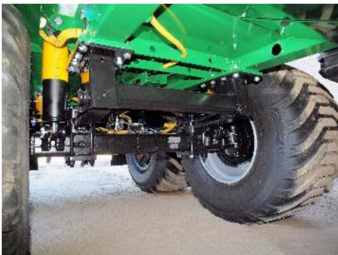
Lors de la conduite en mode transport, le bogie est automatiquement centré et le balancement par rapport au tracteur ne provoque pas de patinage des roues ni de direction directionnelle accidentelle. L'ensemble tracteur-citerne demeure exceptionnellement stable.
