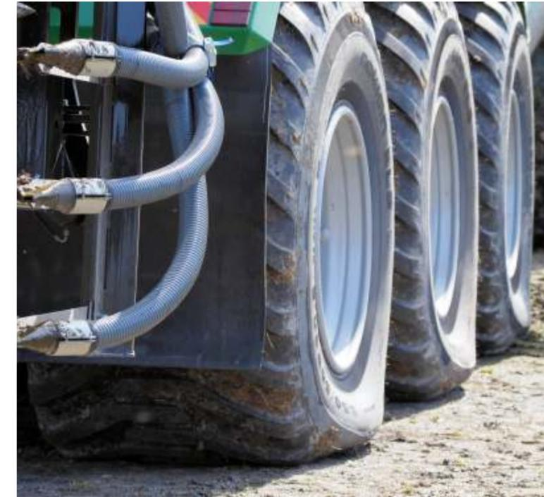
La pression de surface peut être réduite de 50 % grâce au système central de pression des pneus
