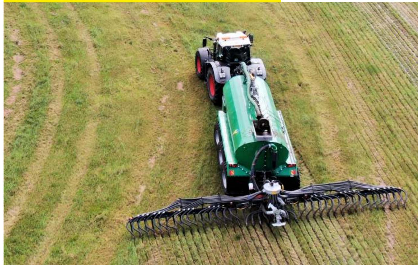
Le châssis de la rampe d'épandage peut pivoter et s'incliner indépendamment de la cuve à lisier.
