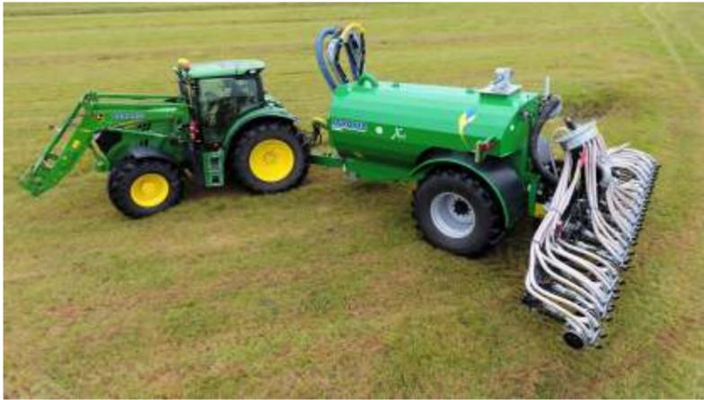
La série AGRONIC XS est une série de tonnes à lisier flexibles à un essieu avec un faible poids total et des pneus de grand diamètre. Ils peuvent être fournis avec un bras de chargement par pompe et une rampe d'épandage.
