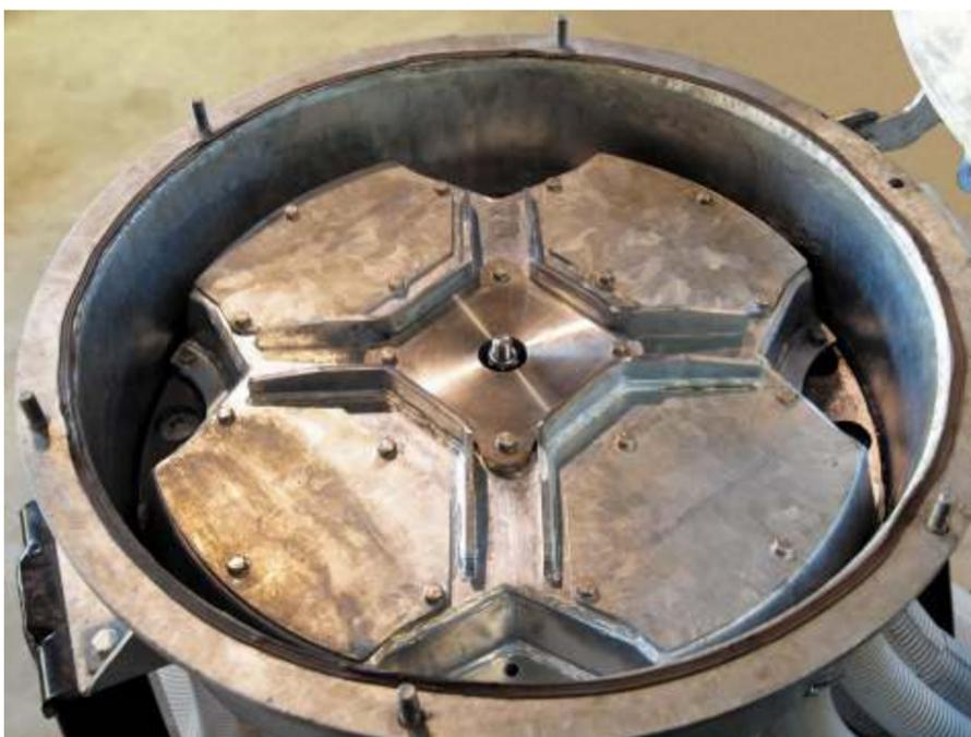
Les lames sont fabriquées à partir de plaques résistantes à l'usure. Le séparateur peut être tourné dans les deux sens.
