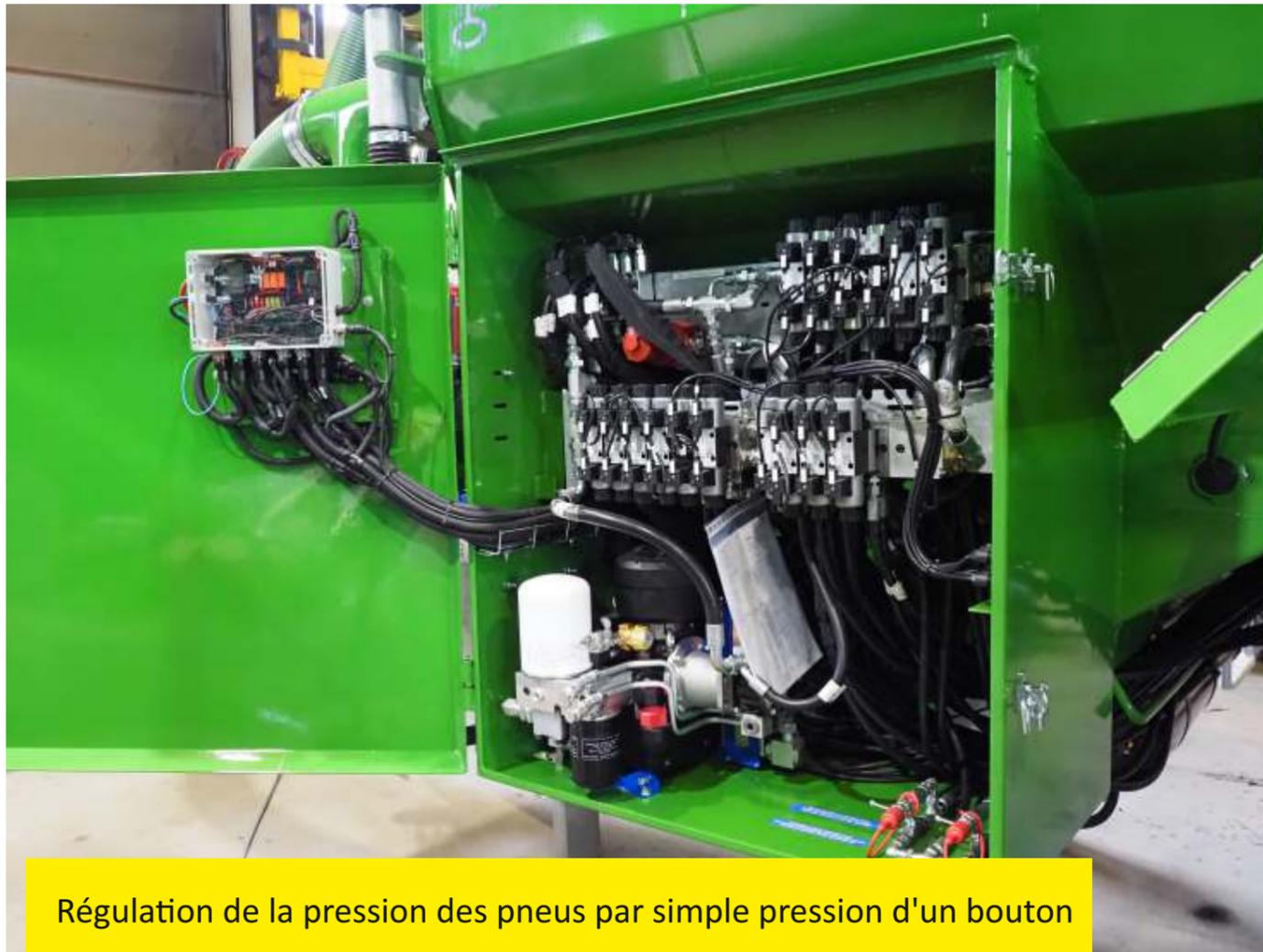
Régulation de la pression des pneus par simple pression d'un bouton
