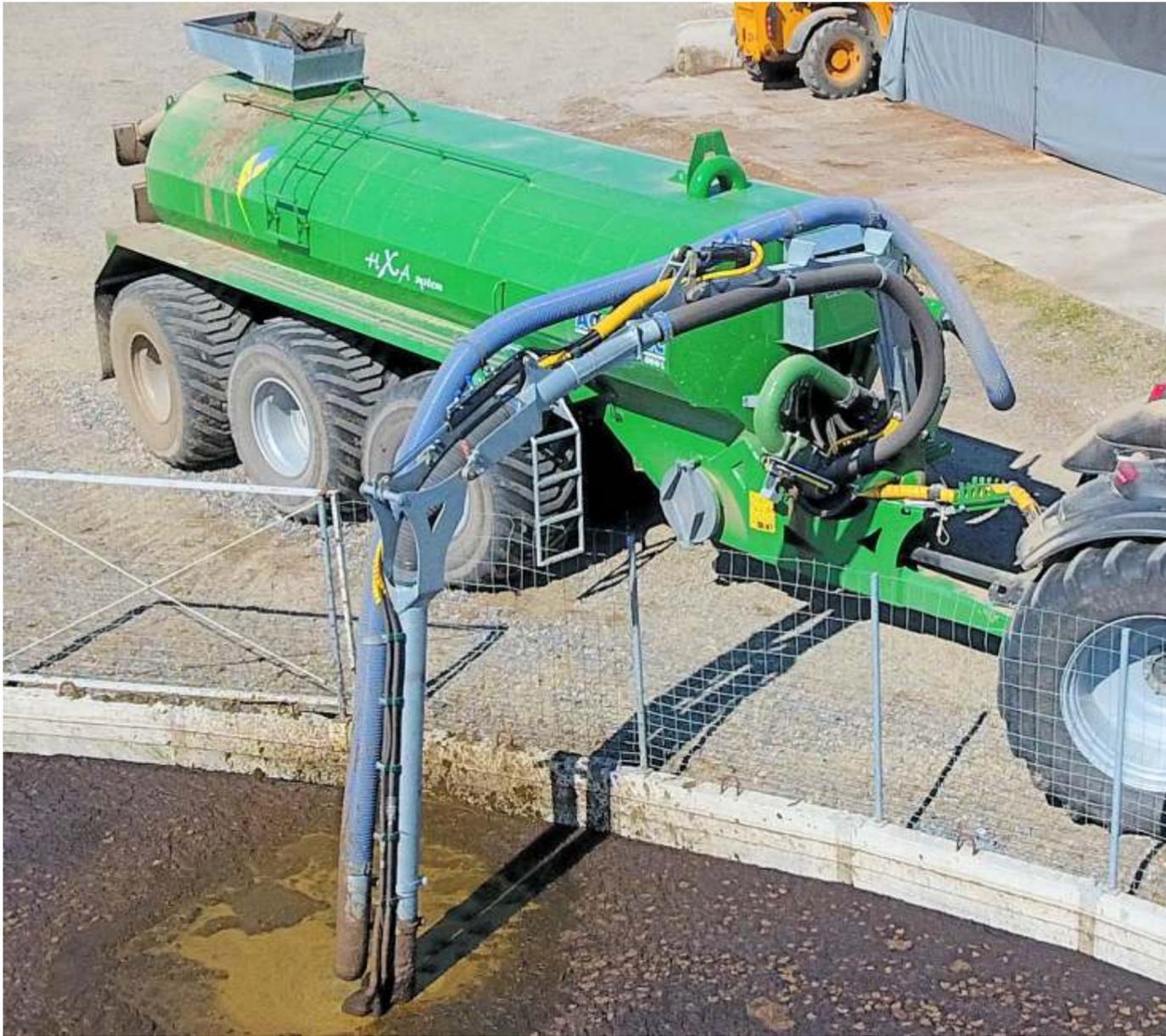
Une couronne dentée, telle qu'utilisée dans les grues de chargement de billots, est utilisée comme dispositif de direction dans le bras de chargement de la pompe.
