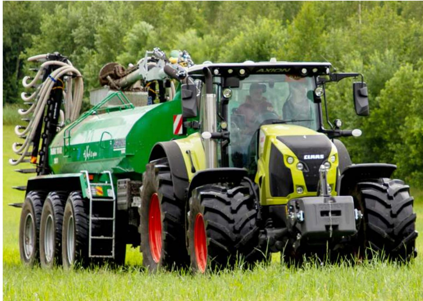
Les tonnes à lisier Agronic ont un centre de gravité bas, tout en offrant une garde au sol appropriée. Il est possible de rouler avec une tonne à lisier pleine sur des pentes/collines et de conserver une bonne stabilité. La garde au sol est maintenue à 40 cm (15 3/4"). Les tonnes à lisier sont équipées de 3 à 4 déflecteurs intérieurs, selon la taille et le modèle, pour éviter le ballonnement et maintenir le contrôle.
