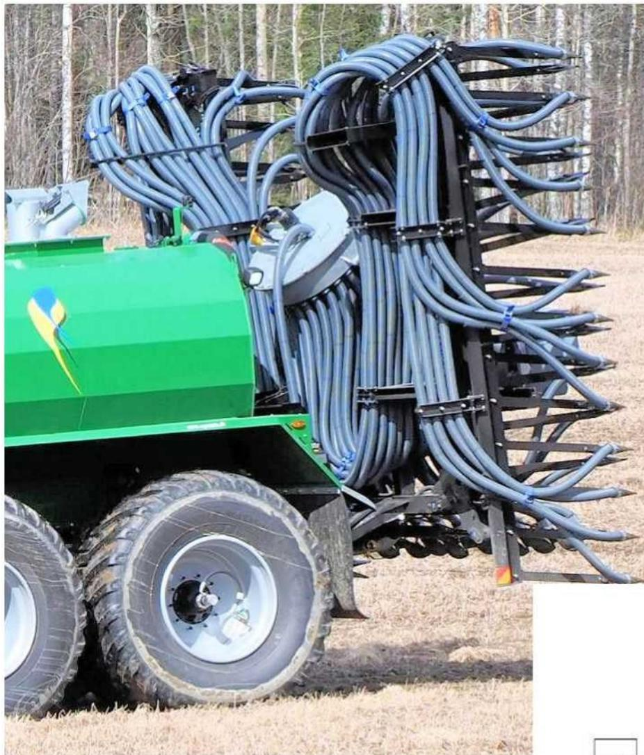
Транспортное положение компактно, складывание «крыльев» автоматизировано.
