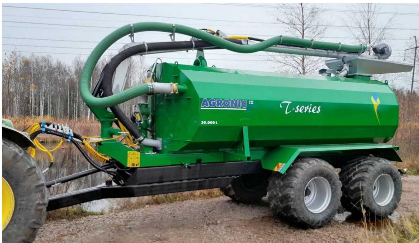
Мы также производим и адаптируем цистерны **Agronic серии T** для установки на шасси тракторных прицепов. Сливной насос с карданным или гидравлическим приводом. При постановке загрузочной стрелы в транспортное положение можно производить слив через шланг для отвода пены. Прицеп оснащен двумя разбрасывающими пластинами в задней части, что позволяет использовать его для распыления удобрения в поле.
