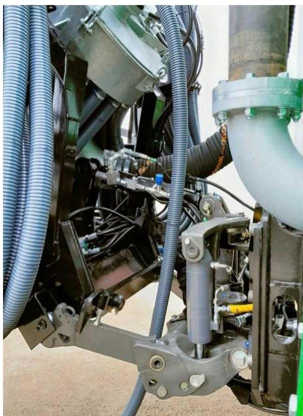
**Уникальное подъемно-поворотное устройство** позволяет поворачивать культиватор относительно прицепа.
