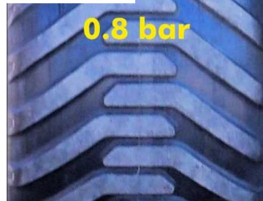
Нагрузка на одно колесо 4667 кг, давление 0,8 бар, контактная поверхность колеса: ширина 750 мм, длина 700 мм
