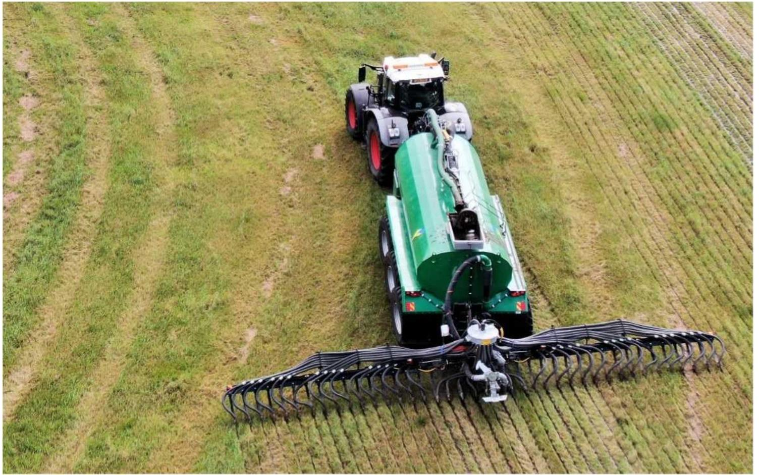
**Корпус инжектора может наклоняться и поворачиваться независимо от прицепа.**
