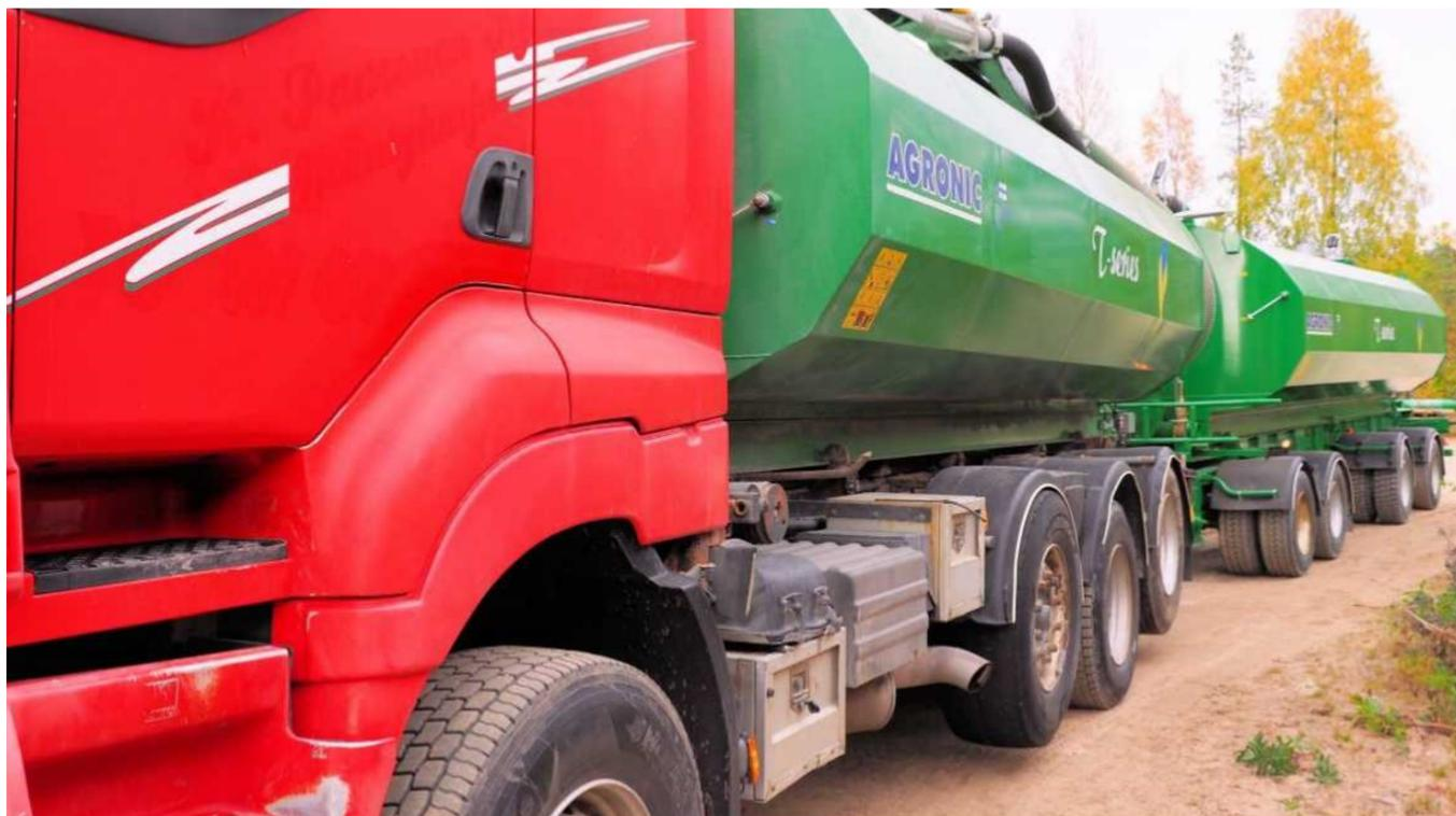
Мы изготавливаем и адаптируем цистерны **Agronic серии T** для возможности их установки на шасси разных моделей грузовых автомобилей и автоприцепов. Комплектуем загрузочными стрелами, гидравликой, электронной системой управления.
