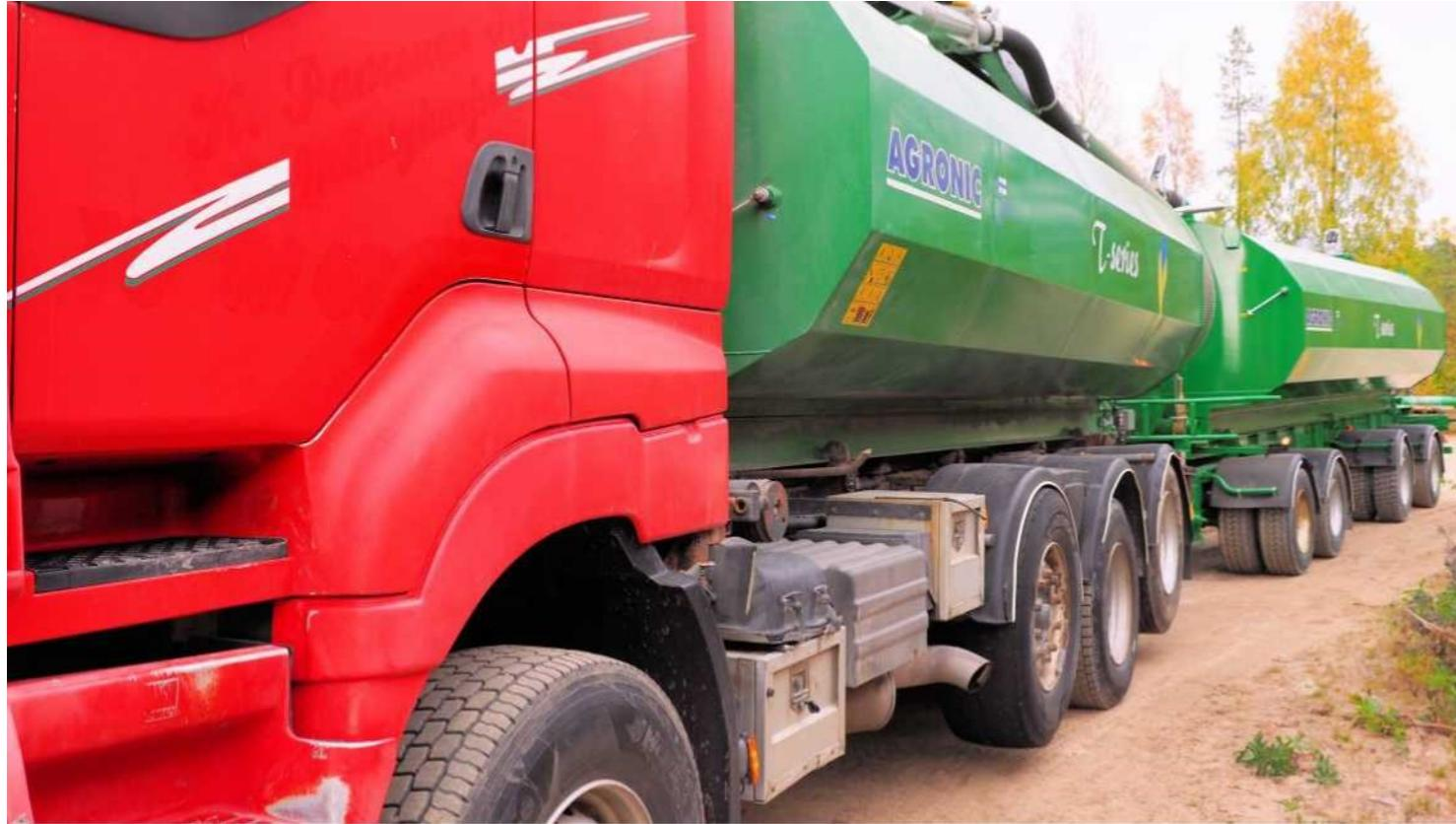
Мы изготавливаем и адаптируем цистерны **Agronic серия Т** для возможности их установки на шасси разных моделей грузовых автомобилей и автоприцепов. Комплектуем загрузочными стрелами, гидравликой, электронной системой управления.
