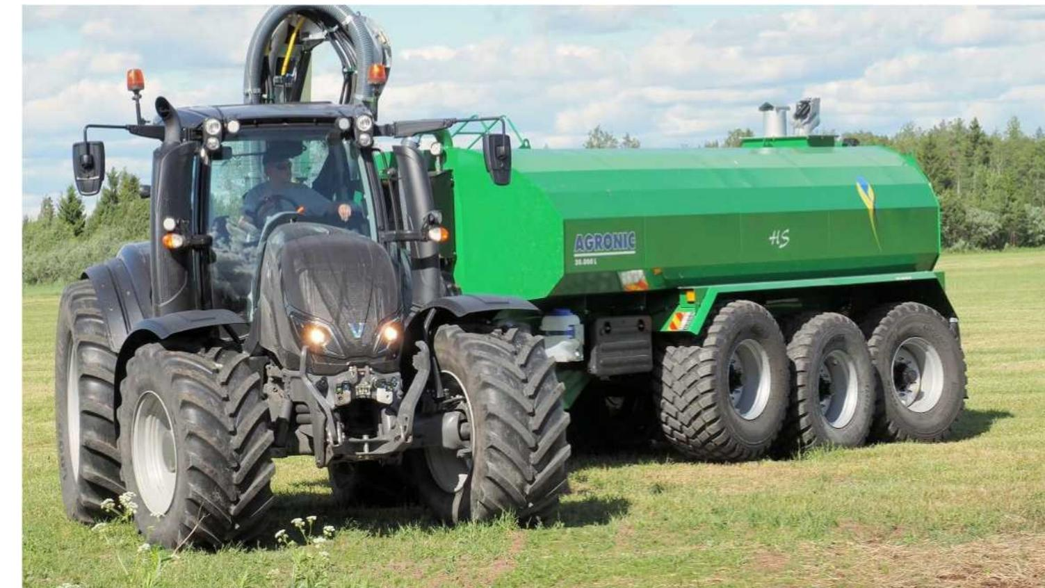
**Серия AGRONIC HS.** На фото прицеп с дорожными колесами, подготовленный к транспортировке груза. Благодаря низкому расположению центра тяжести, правильному распределению веса и гидравлической подвеске прицеп можно буксировать с большой скоростью с сохранением плавности движения. Подъемная передняя ось входит в базовую комплектацию трехосных прицепов.
