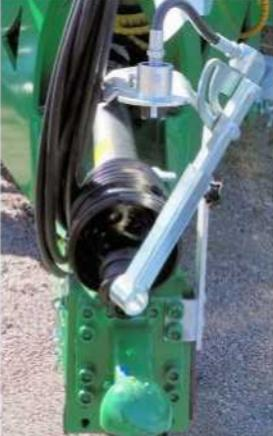
Рычаг датчика, показанного на рисунке, соединен с точкой крепления центральной тяги трактора.
