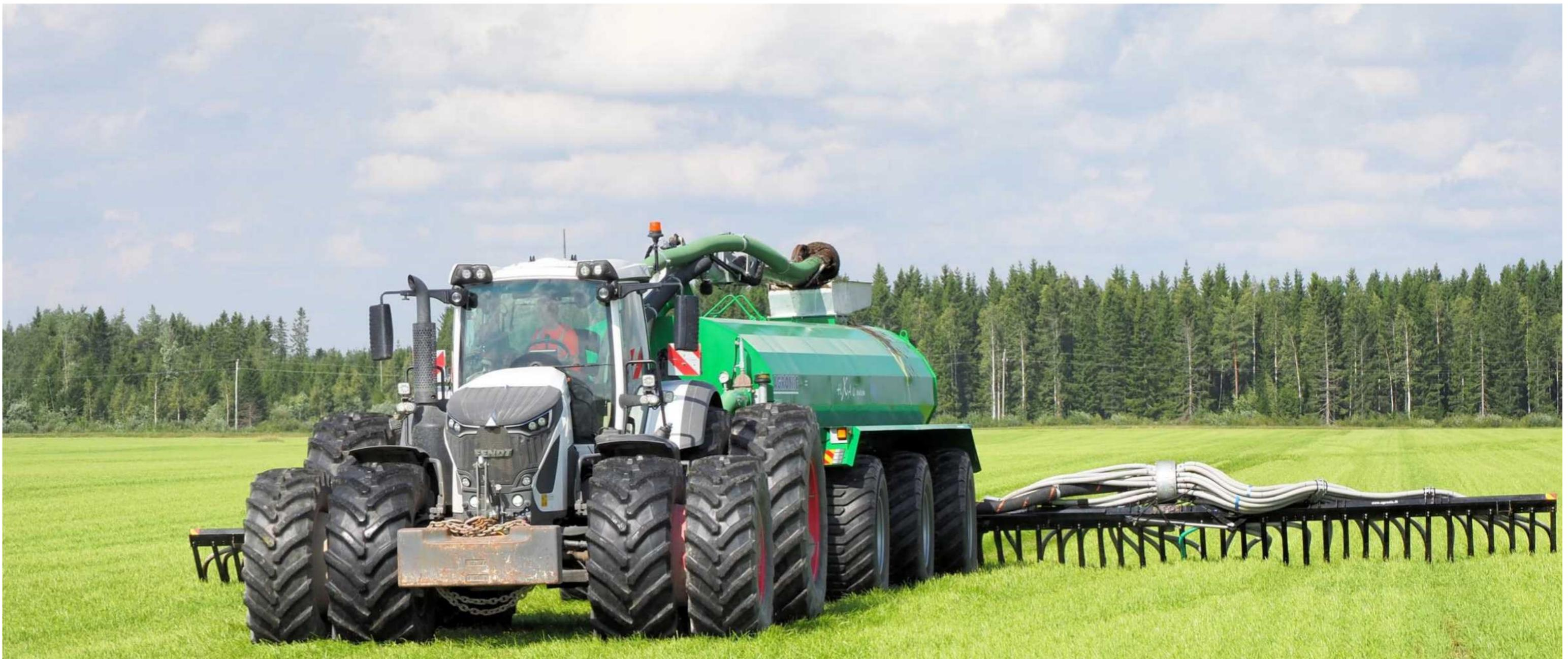
С помощью системы крабового хода **AGRONIC** можно направлять прицеп по траектории, отличной от траектории трактора. Снижается риск «вытаптывания» поля и увязания трактора. Система крабового хода подключается к системе автоматического разворота трактора в конце полосы так, что переключение между режимами крабового хода и принудительного управления происходит автоматически.
