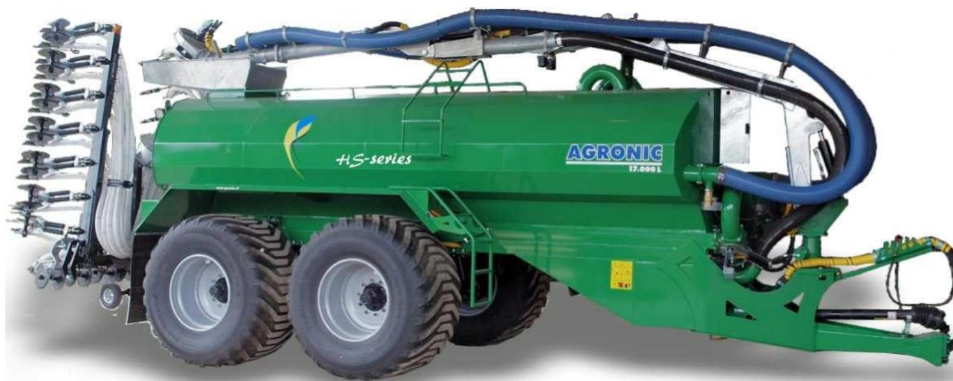
**Серия Agronic HS.** Двух- и трехосные цистерны на гидравлической подвеске с гидравлической системой фрикционного управления и низким центром тяжести.
