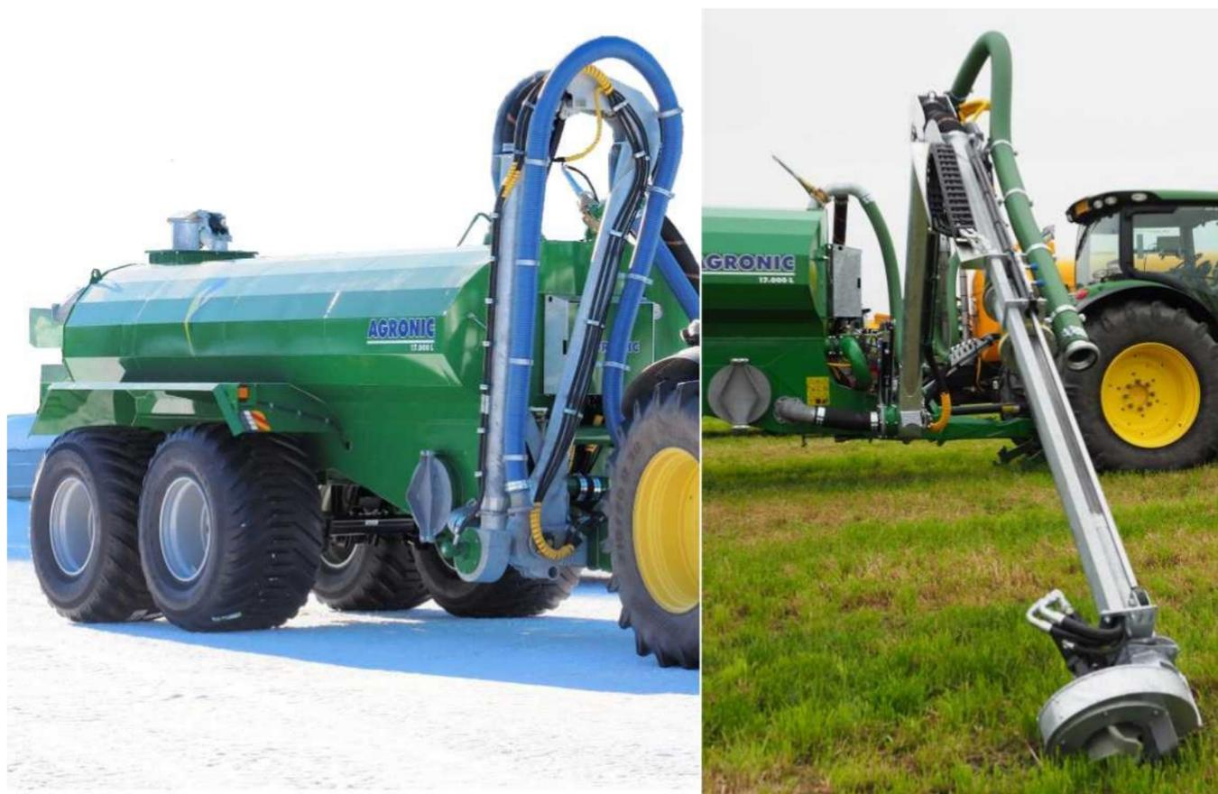
**Загрузочная стрела AGRONIC с боковым креплением** обеспечивает эффективное и аккуратное наполнение цистерны. Загрузка осуществляется измельчающим гидронасосом через рукав диаметром 168 мм. Загрузочный рукав с обратным клапаном опускается на самое дно цистерны, обеспечивая минимальное пенообразование.
