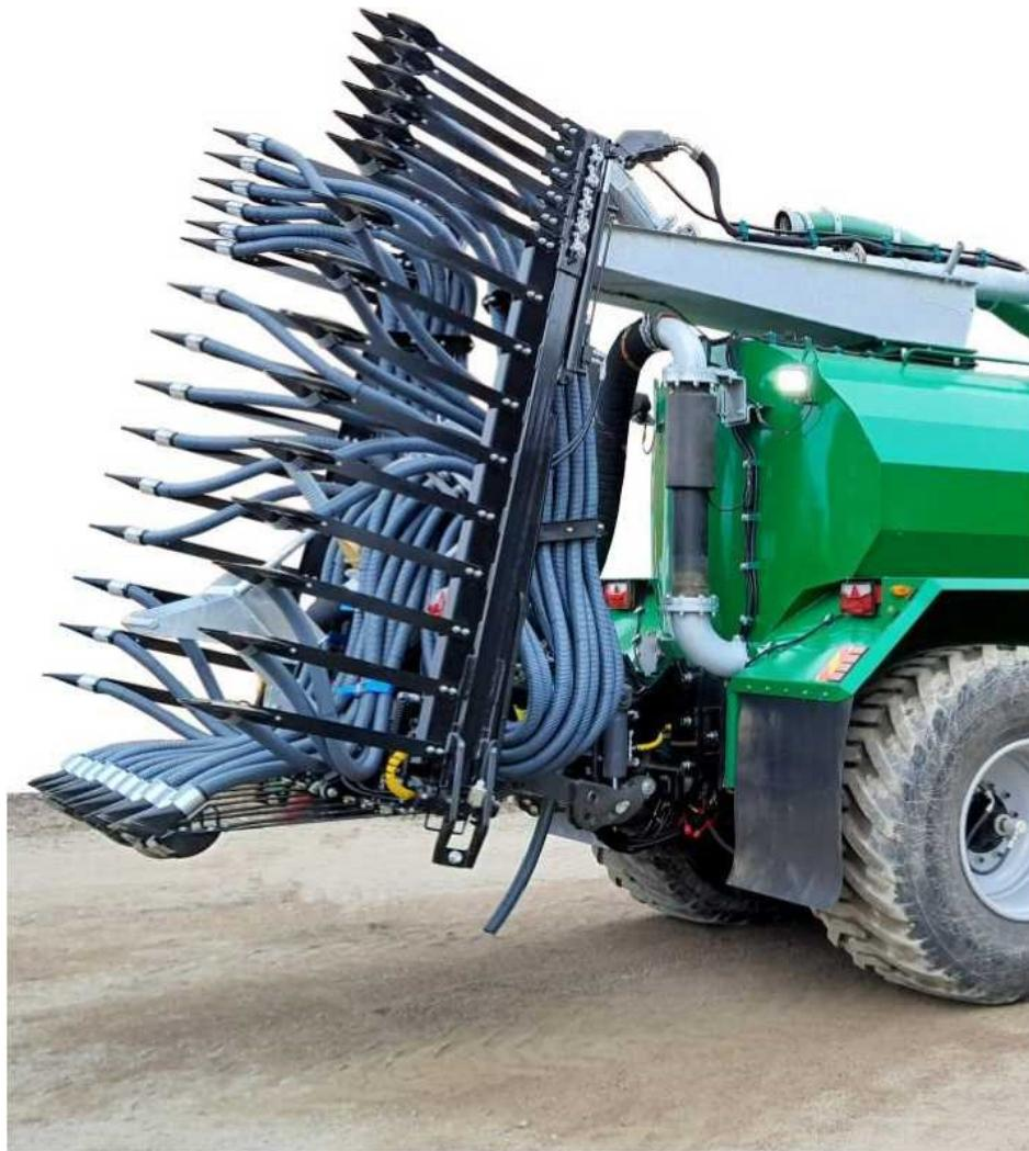
**Инжекторная навеска AGRONIC -TSR 9000** позволяют осуществлять внесение жидкого удобрения непосредственно в почву в течение вегетационного периода. При этом потери питательных веществ и неприятные запахи сводятся к минимуму, а период внесения удобрения может быть продлён.
