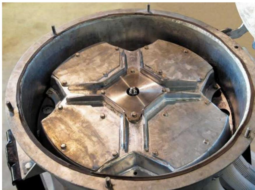
**Измельчающие лезвия распределителя изготовлены из износостойкой стали.**
