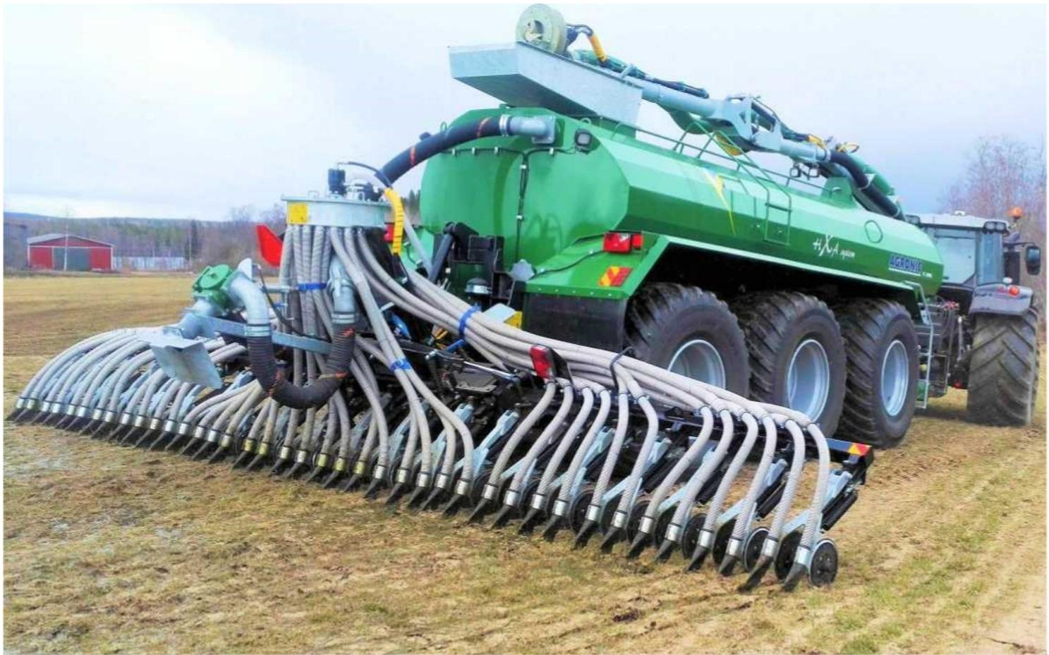
Дисковая навеска AGRONIC плотно прилегает к грунту, повторяя форму поверхности. «Крылья» шарнирно крепятся к центральной части распределительной штанги и поворачиваются, отслеживая неровности поля. Рабочий диапазон заглубления лемехов составляет 0,5 метра.
