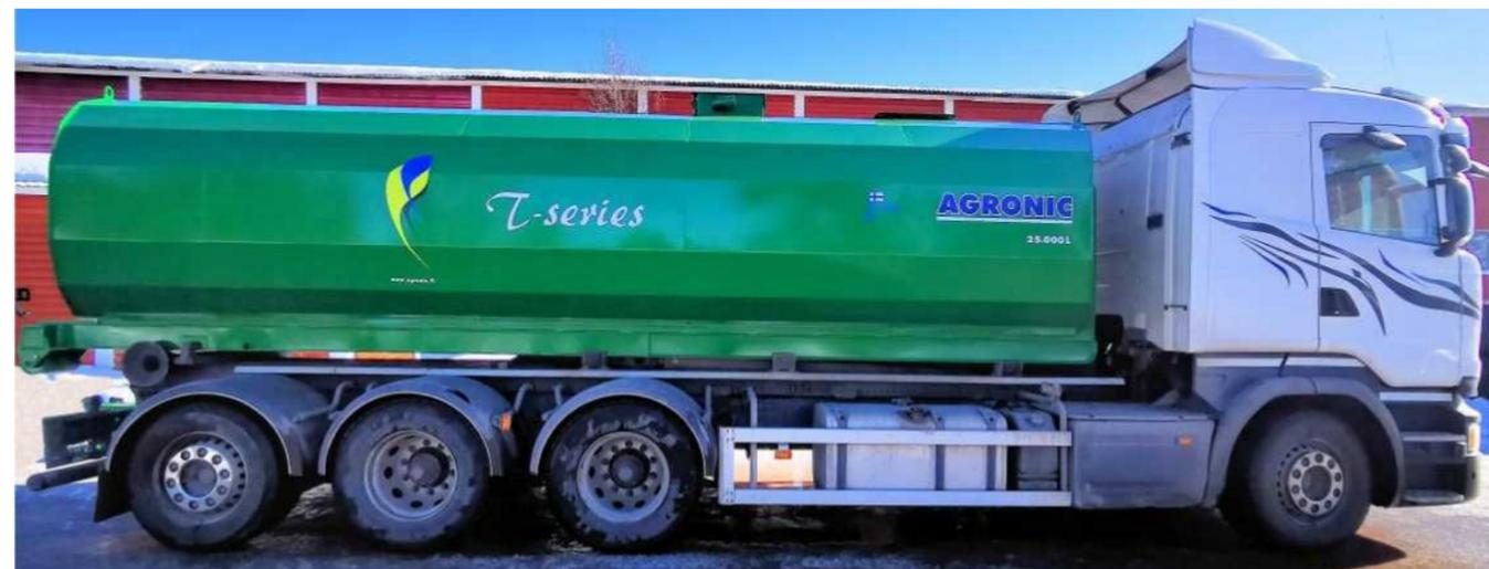
Небольшая высота производимых нами цистерн обеспечивает низкое расположение центра тяжести.
