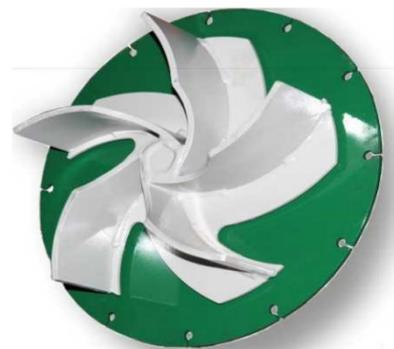
Прицепы-цистерны S, HS и HXA оборудованы мощным пятилопастным сливным насосом с карданным приводом и двухрядными роликоподшипниками.
