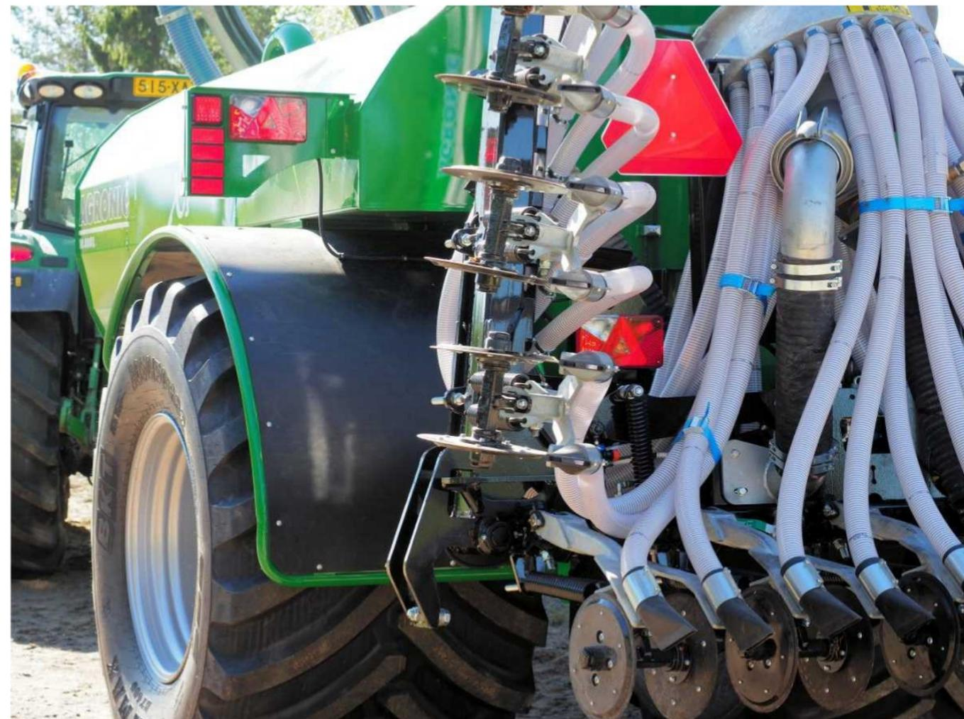
**Радиальные шины 1050/50R32, фонари и брызговики в базовой комплектации**
