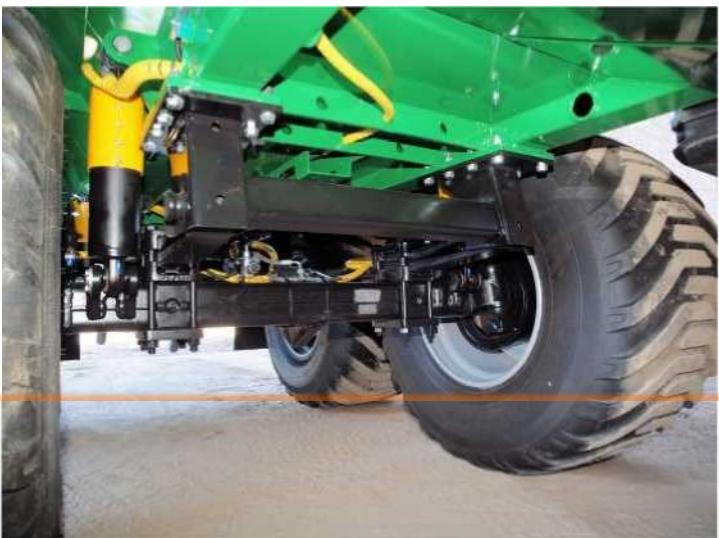
При движении по дороге автоматика фиксирует оси прицепа строго в среднем положении. На трассе качание трактора или прицепа не приводит к повороту колес, система очень устойчива и безопасна.
