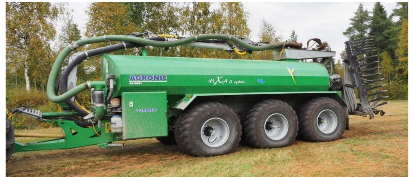
**Преимущества при работе в поле при давлении в шинах 0,8 бар по сравнению с нормальным дорожным давлением 3 бар.** Площадь поверхности прилегания шины к грунту увеличивается вдвое -> давление на поверхность уменьшается вдвое -> нет уплотнения почвы -> **ЛУЧШЕ УРОЖАЙ**
