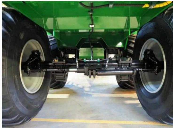
Ходовая часть цистерн **AGRONIC-S** имеет маятниковую подвеску ADR с параболическими рессорами, фрикционным управлением и гидравлическими тормозами в базовой комплектации.
