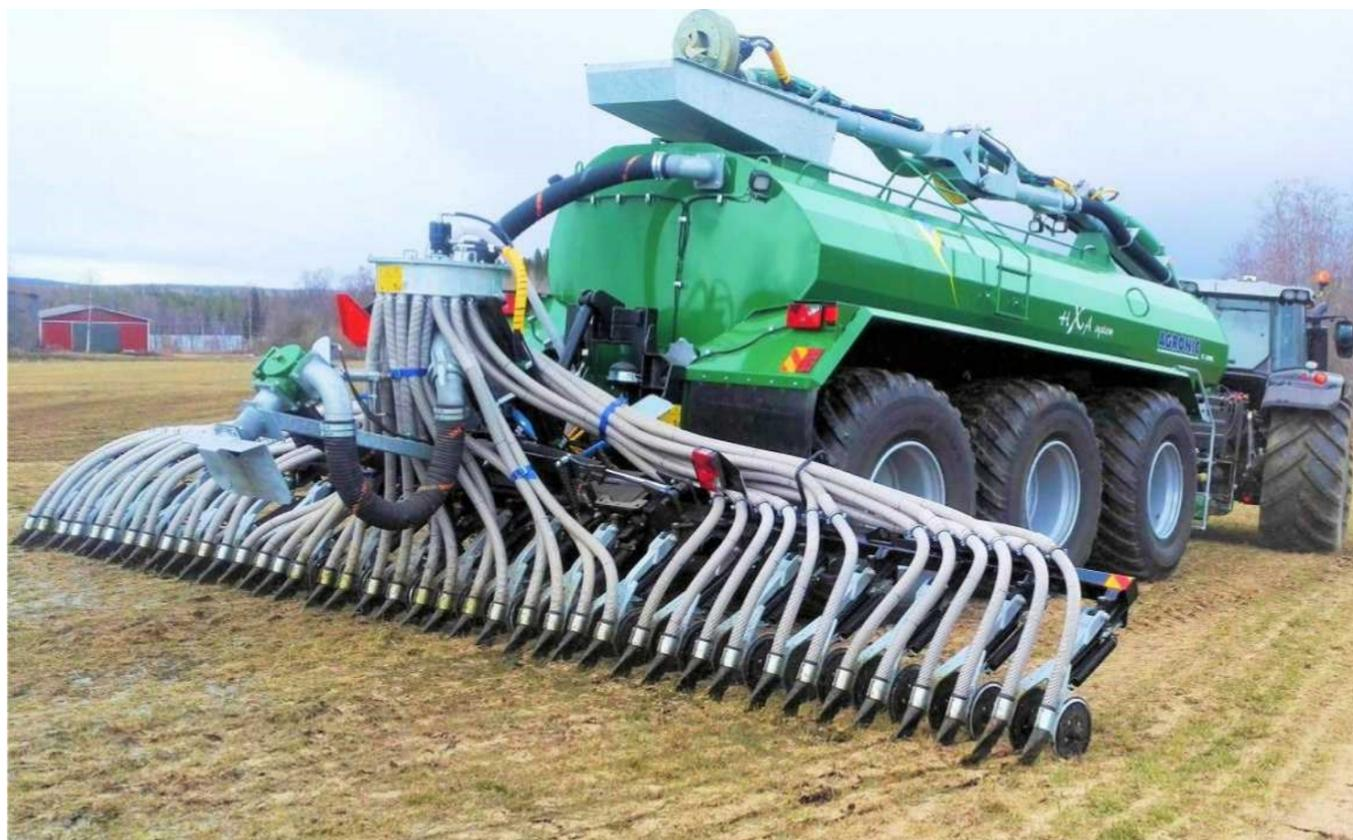
Дисковая навеска AGRONIC плотно прилегает к грунту, повторяя форму поверхности. «Крылья» шарнирно крепятся к центральной части распределительной штанги и поворачиваются, отслеживая неровности поля. Рабочий диапазон заглубления лемехов составляет 0,5 метра.
