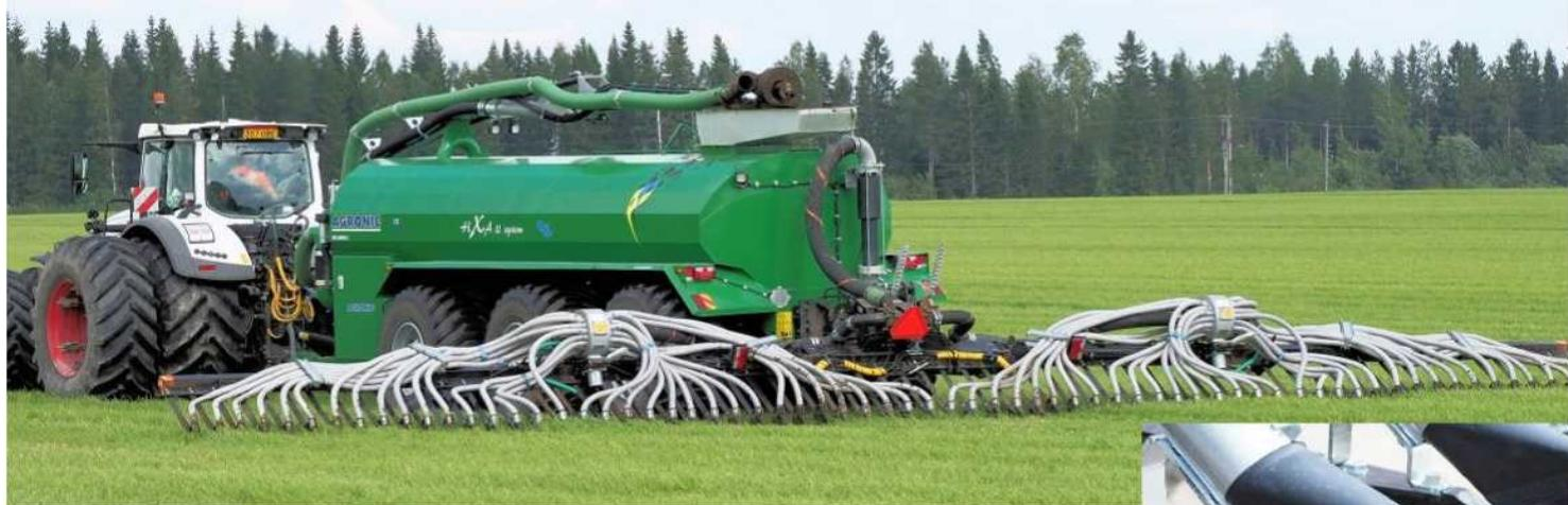
Модель TSR 12000 может быть оснащена двумя эксцентрическими распределительными штангами от датской компании Harsö. Их применение дает возможность работать с половиной шириной, сократить длину рукавов и уменьшить расстояние между лемехами.
