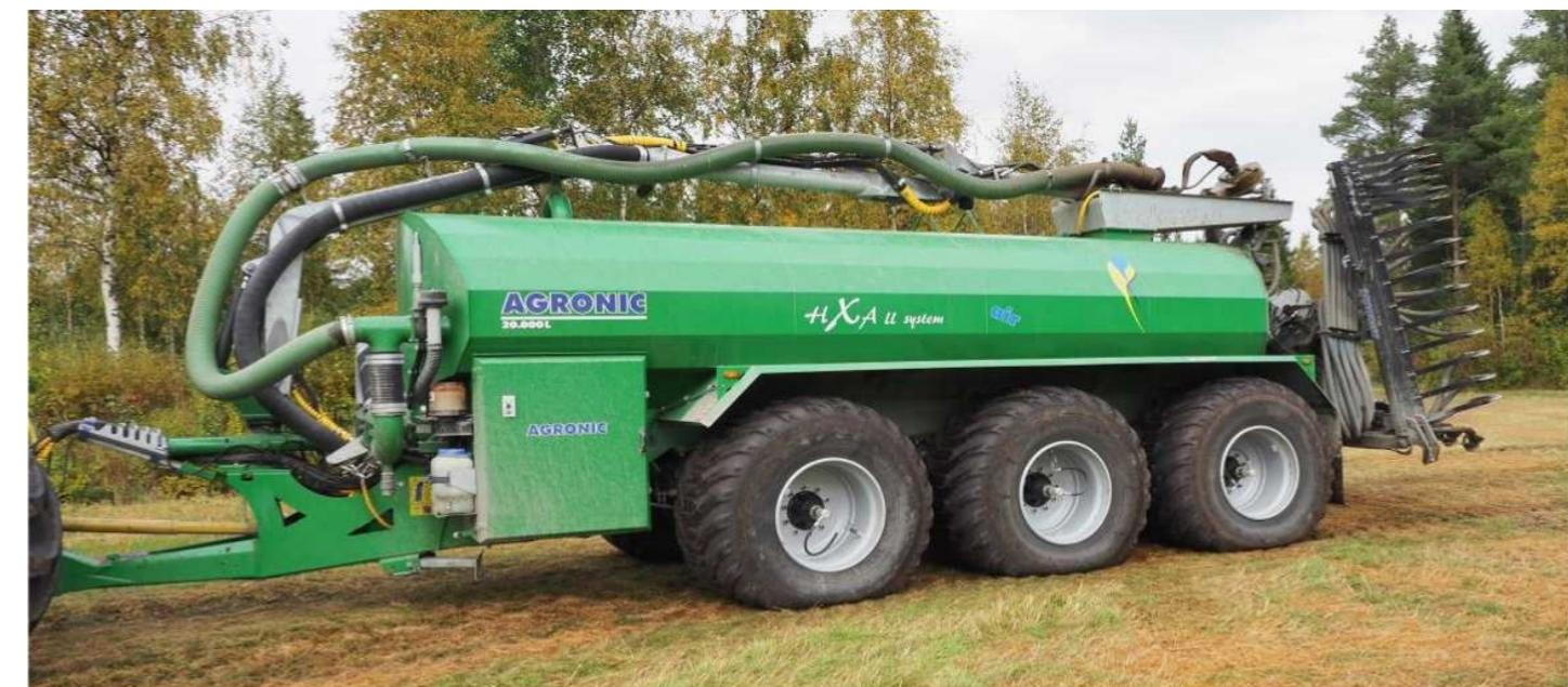
Преимущества при работе в поле при давлении в шинах 0,8 бар по сравнению с нормальным дорожным давлением 3 бар. Площадь поверхности прилегания шины к грунту увеличивается вдвое -> давление на поверхность уменьшается вдвое -> нет уплотнения почвы -> **ЛУЧШЕ УРОЖАЙ**
