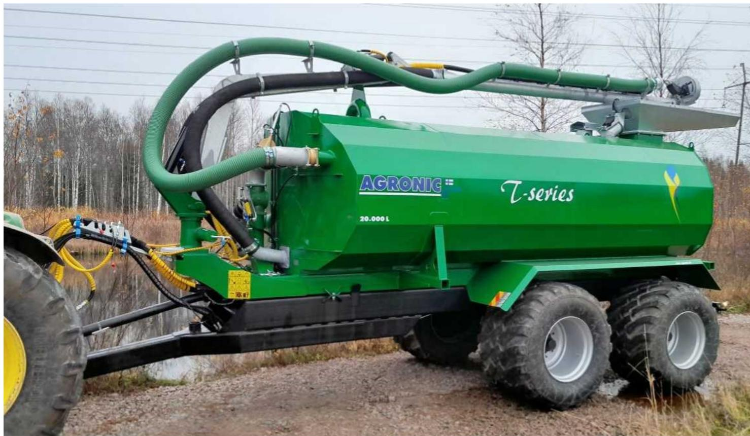
Мы также производим и адаптируем цистерны **Agronic серия Т** для установки на шасси тракторных прицепов. Сливной насос с карданным или гидравлическим приводом. При постановке загрузочной стрелы в транспортное положение можно производить слив через шланг для отвода пены. Прицеп оснащен двумя разбрасывающими пластинами в задней части, что позволяет использовать его для распыления удобрения в поле.
