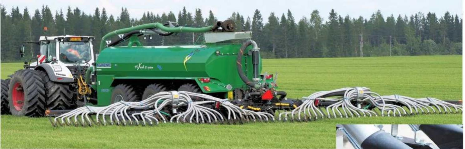
Модель TSR 12000 может быть оснащена двумя эксцентрическими распределительными штангами от датской компании Harsö. Их применение дает возможность работать с половинной шириной, сократить длину рукавов и уменьшить расстояние между лемехами.
