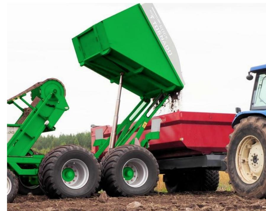
Высота разгрузки бункера составляет 250 см.
