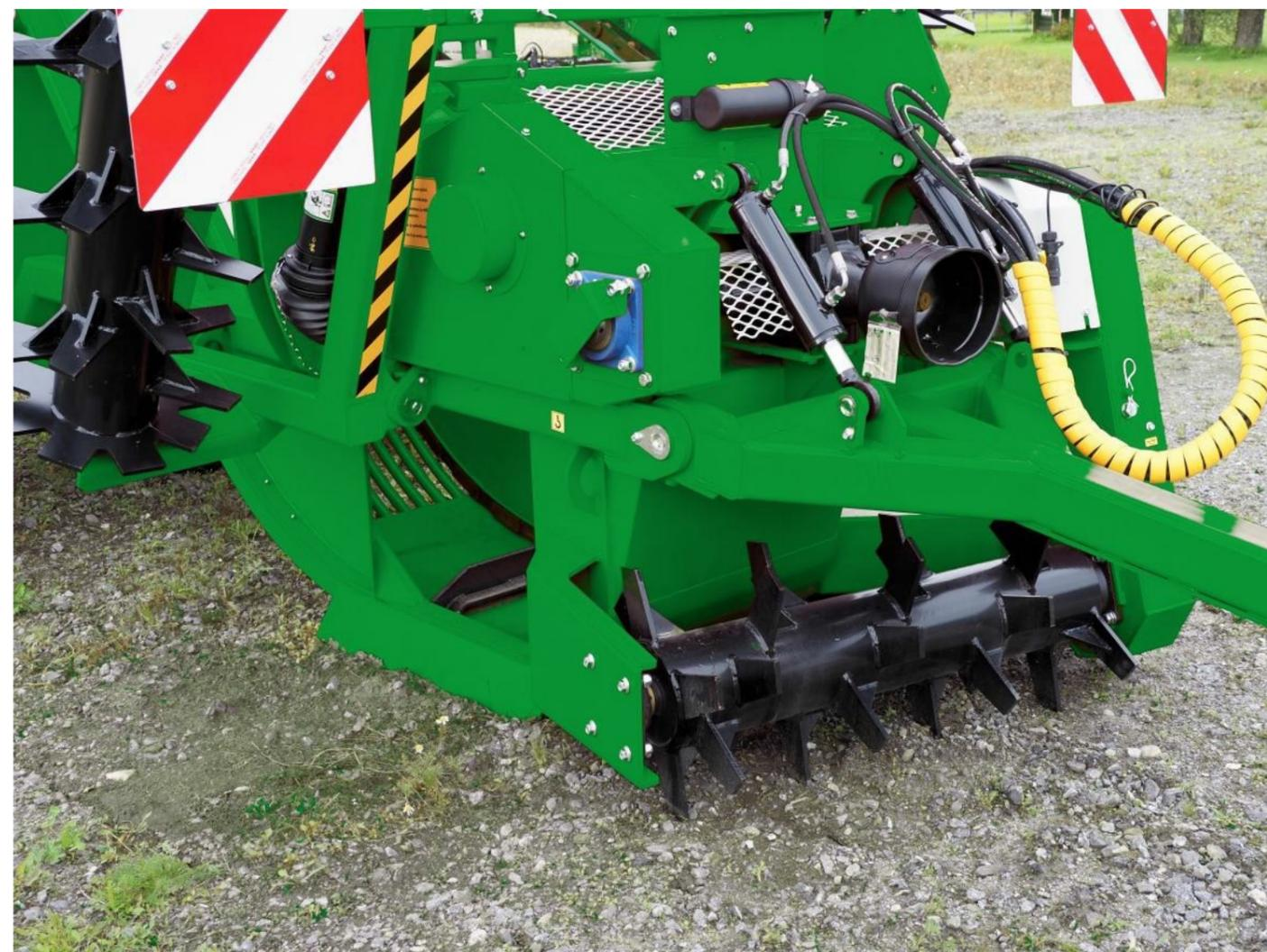
Центральный ротор не вдавливают камни в землю «выкапывая» их на поверхность. А также выравнивает рельеф и проводит первичную обработку почвы, не повреждая плодородный слой почвы.
