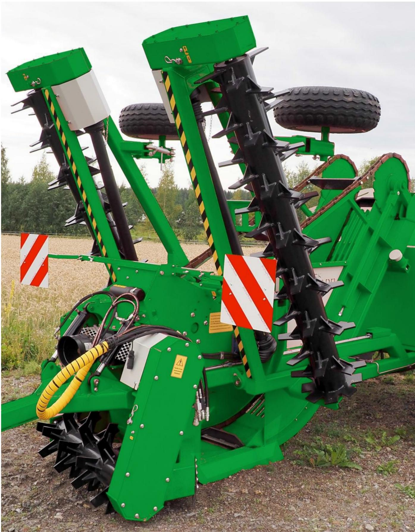
Т-образный редуктор Bondioli передает мощность на передний/центральный ротор посредством роликовой цепи и, защищающей трансмиссию, предохранительной фрикционной муфты. С другой стороны выходного вала центрального редуктора мощность подается на конвейер и боковые роторы через цепные редукторы. Каждая функция камнеподборщика, приводимая от ВОМ трактора снабжена отдельной "фрикционкой" для защиты трансмиссии от перегрузки. Используются высококачественные комплектующие от Bondioli.
