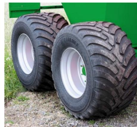
Ведущие радиальные шины, хорошие ходовые качества при движении на дороге и в поле. Возможны три размера колес. Гидравлические тормоза входят в базовую комплектацию.
