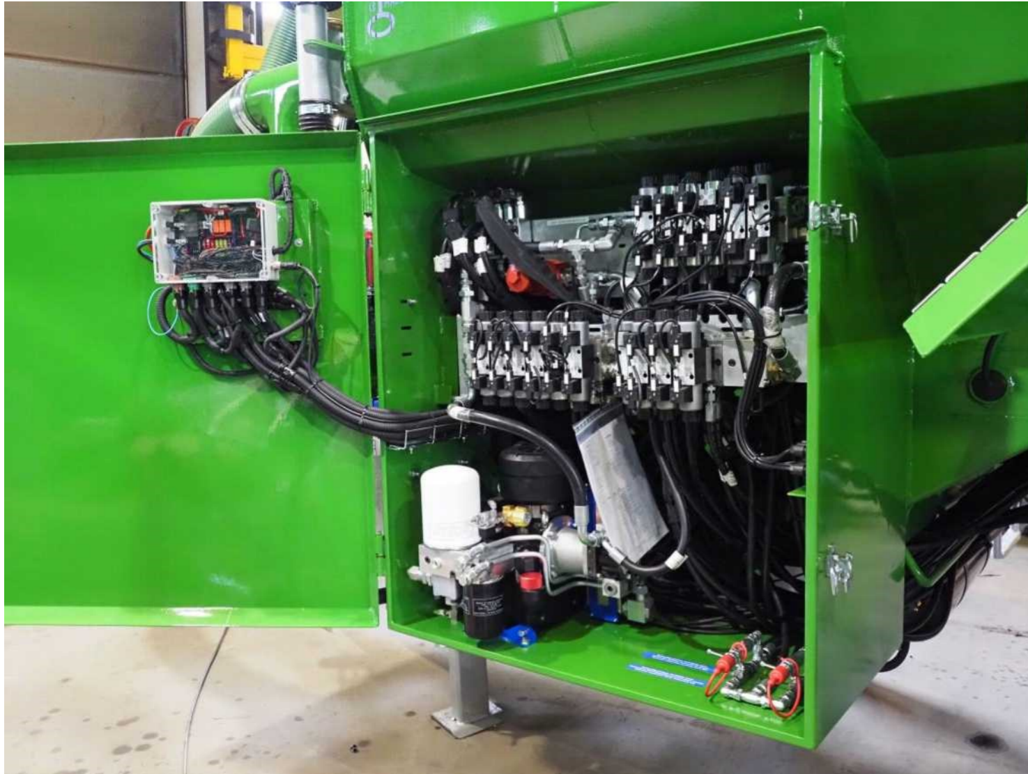
Пневмосистема Air полностью интегрирована в систему управления прицепом. Компрессор расположен в гидравлическом шкафу.
