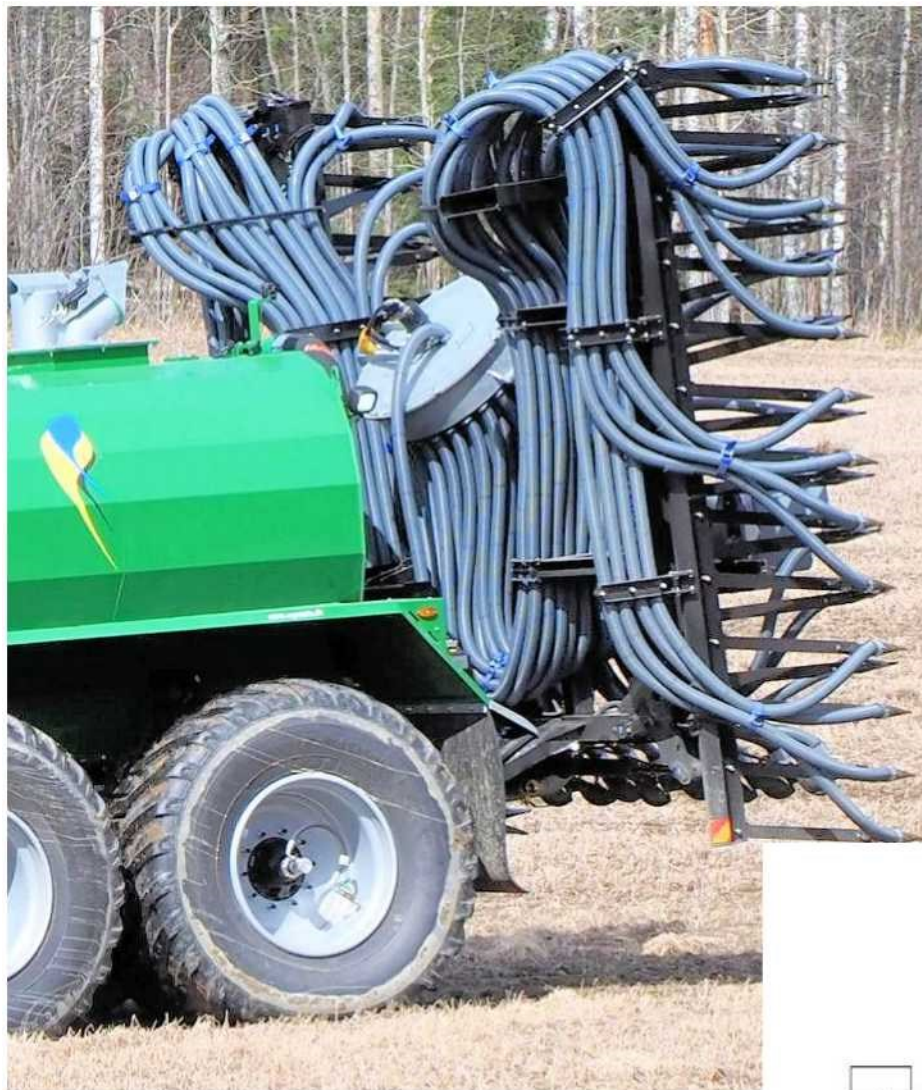
Транспортное положение компактно, складывание «крыльев» автоматизировано.
