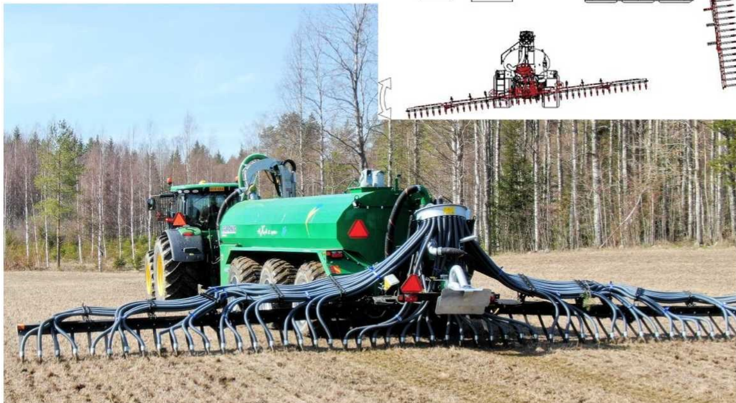
Транспортное положение компактно, складывание «крыльев» автоматизировано.
