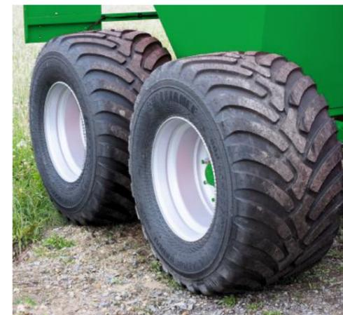
Des pneus porteurs à ceinture d'acier et un train de roulement robuste assurent une bonne maniabilité aux champs et sur route. Trois options de pneus sont disponibles et les freins hydrauliques sont de série.
