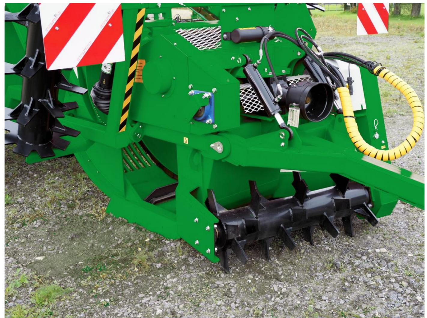
Le rotor avant traite le sol à une profondeur de travail normale au centre de la machine. Il ne pousse pas les pierres dans le sol, mais les soulève. La surface du champ est également plate au centre de la machine.
