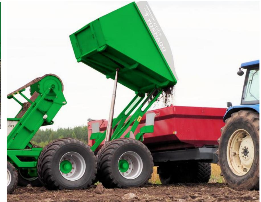
Le convoyeur déplace les pierres vers le haut et les laisse tomber dans la trémie. La hauteur de levage de la trémie est de 250 cm (8').
