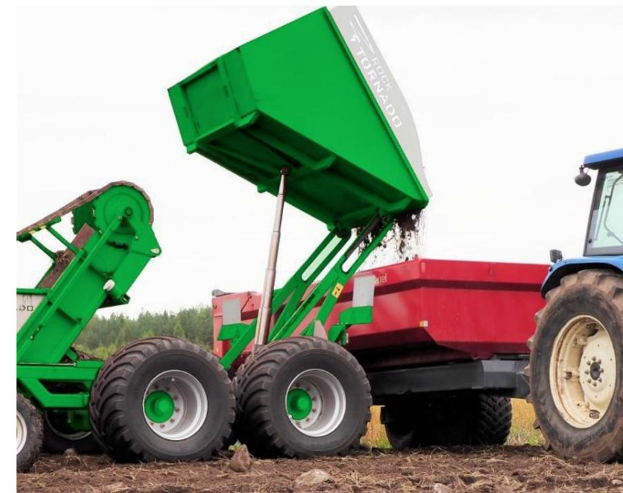
Высота разгрузки бункера составляет 250 см.
