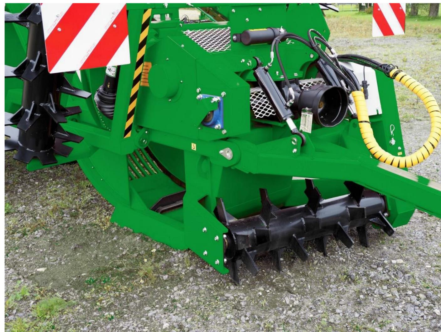
Передний ротор обрабатывает почву на нормальной рабочей глубине от центра машины, не вдавливает камни в землю, а извлекает их из нее. Поверхность поля остается ровной даже под центральной частью машины.
