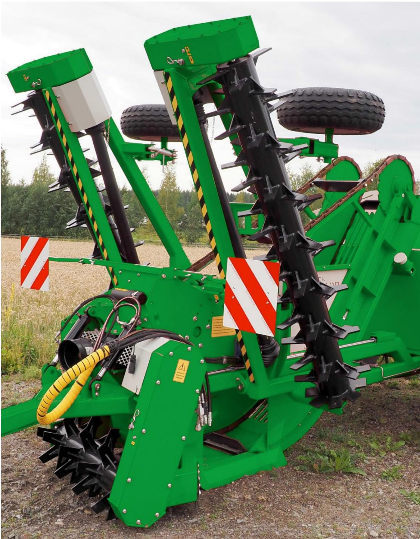
T-образный редуктор Bondioli передает мощность на передний/центральный ротор по средствам роликовой цепи и, защищающей трансмиссию, предохранительной фрикционной муфты. С другой стороны выходного вала центрального редуктора мощность отбирается на конвейер и боковые роторы через цепные редукторы. Каждая функция камнеподборщика, приводимая от ВОМ трактора снабжена отдельной "фрикционкой" для защиты трансмиссии от перегрузки. В машине применены высококачественные комплектующие от Bondioli.
