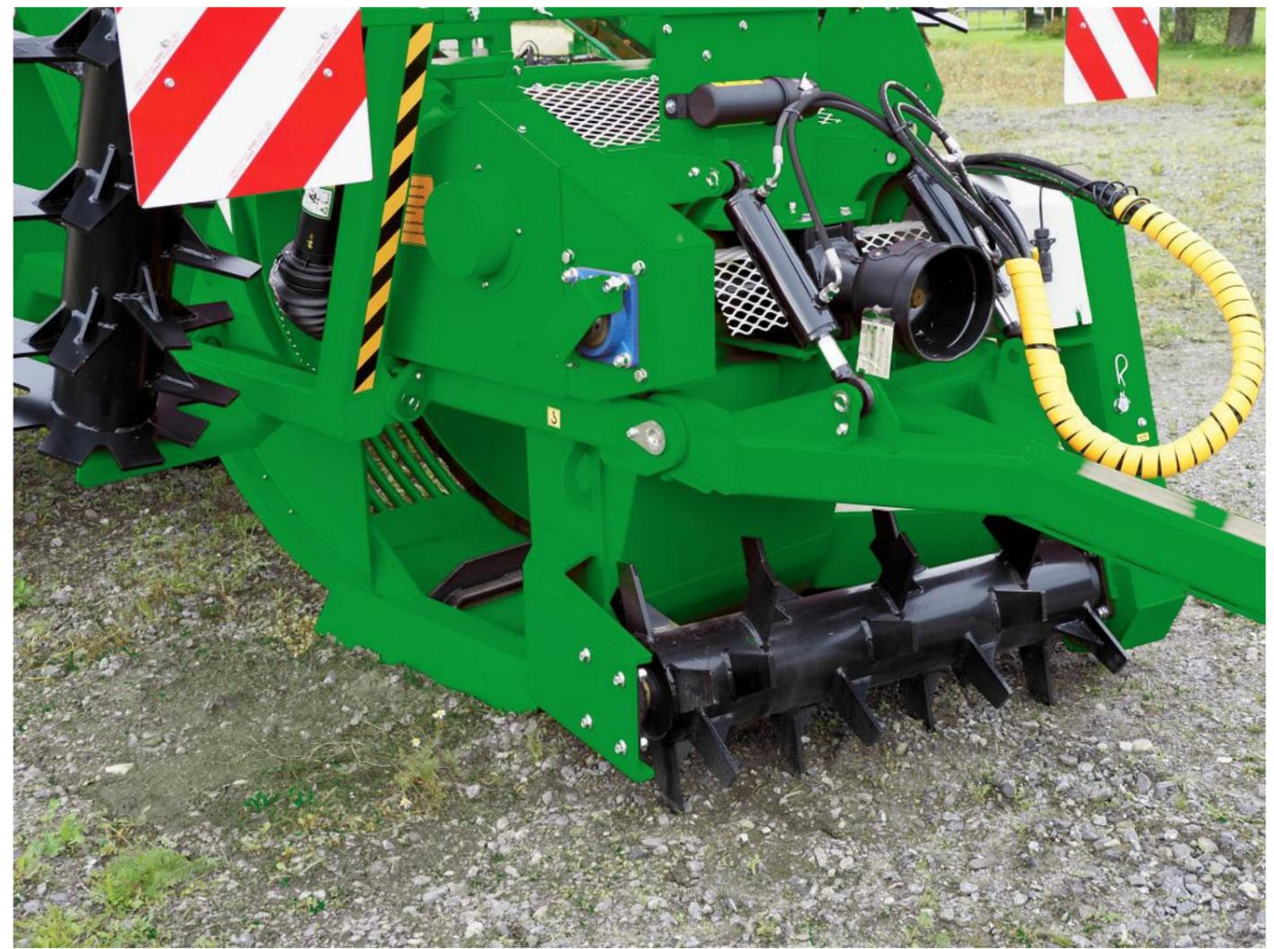
El rotor delantero trabaja la tierra con la profundidad normal de trabajo en el centro de la máquina, no presiona las piedras en el suelo, sino que las levanta fuera de la tierra. La superficie del campo queda nivelada también en el centro de la máquina.
