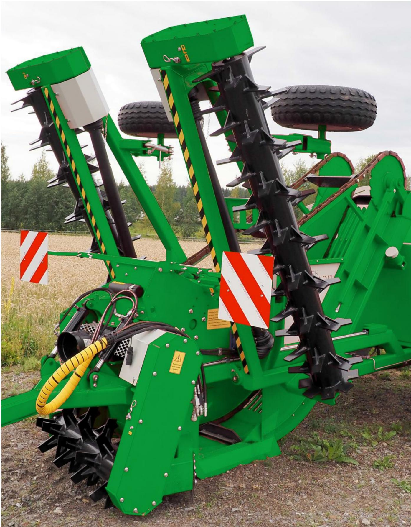
Desde el engranaje en ángulo del modelo T la fuerza se transmite a través de la transmisión de cadena y del embrague de fricción hasta el rotor delantero. El otro lado transmite la fuerza a través de la cadena doble al transportador y a los rotores laterales. Cada función tiene su propio embrague de fricción para proteger la transmisión de fuerza ante la sobrecarga. Utilizamos componentes Bondioli de alta calidad. La criba abarca todo el transportador, por lo tanto las piedras se limpian bien.
