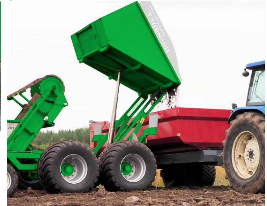
El transportador transporta las piedras al depósito por arriba. La altura de vaciado del depósito es de 250 cm.
