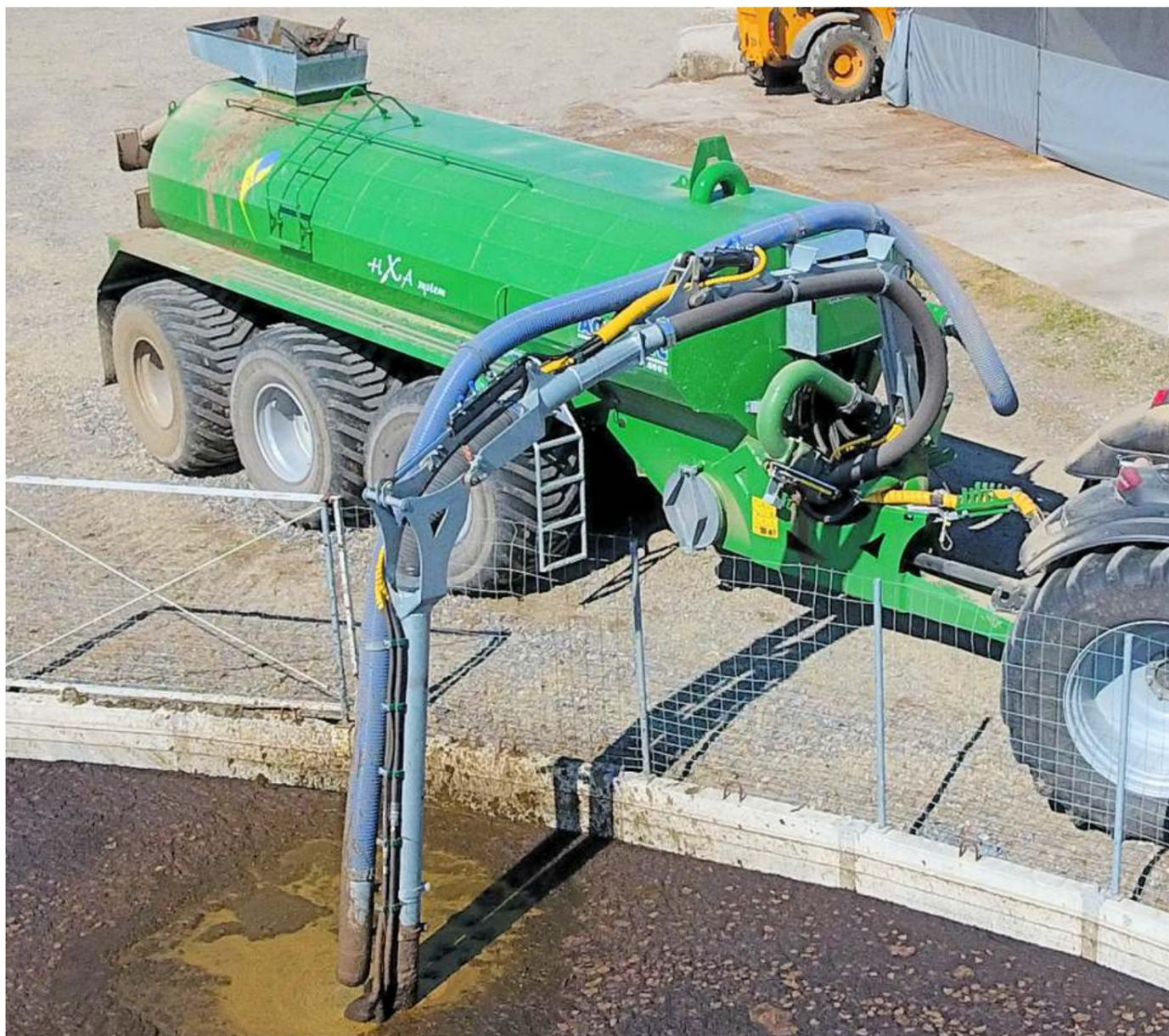
Le bras de pompage AGRONIC monté au centre peut pivoter de chaque côté de la tonne à lisier pour le chargement. Un système d'engrenage à pignon solide, comme celui utilisé dans les grues forestières, est utilisé dans le mécanisme de pivotement.
