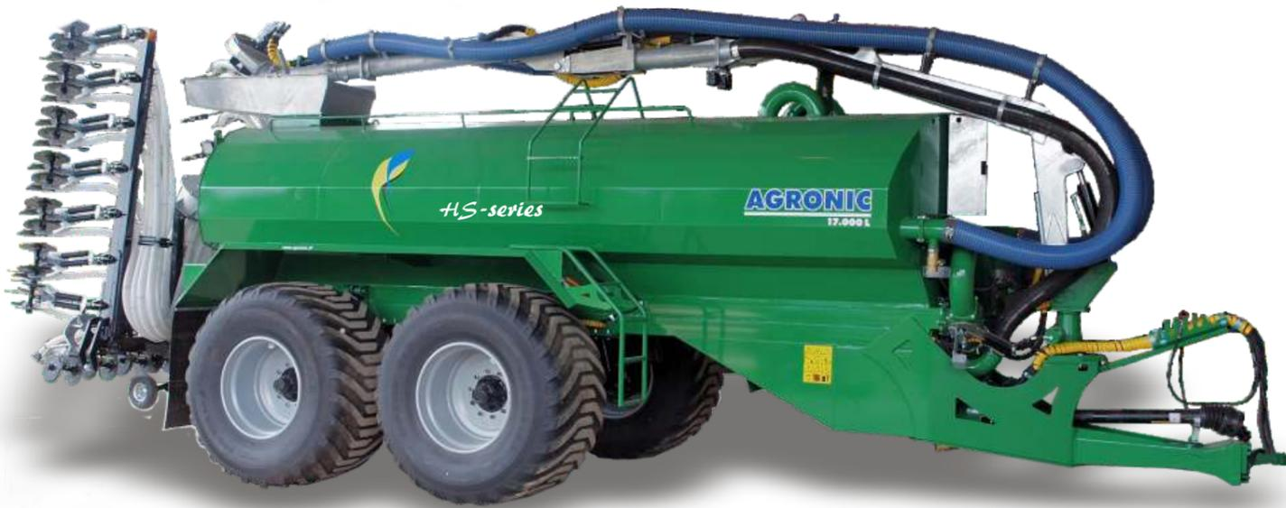
Les tonneaux à lisier HS d'AGRONIC à essieux tandem et tridem hydrauliques avec direction forcée, suspension hydraulique et centre de gravité bas.
