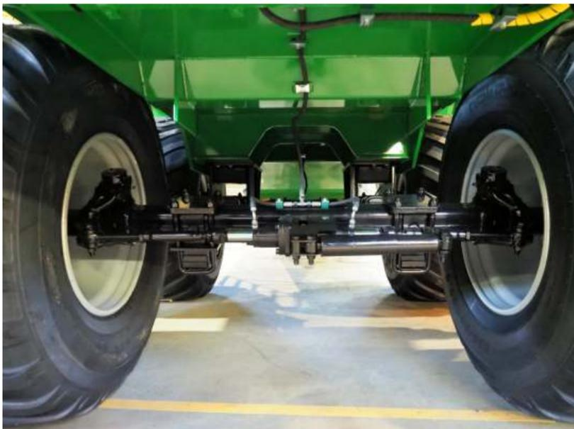
Le jeu d'essieux standard des réservoirs à lisier de la série S d'AGRONIC est un balancier droit à ressort parabolique contrôlé par friction fabriqué par ADR, avec freins hydrauliques.
