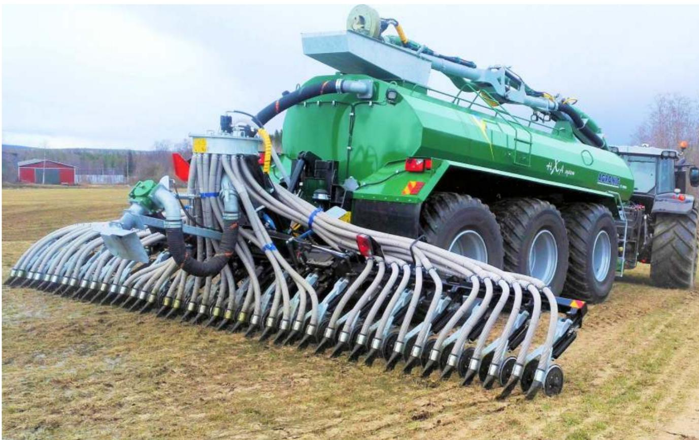
La rampe d'injection à disques Agronic suit précisément la surface du sol, le châssis est articulé au milieu, les ailes peuvent suivre les contours de la surface du sol. Les socs ont une course d'un demi-mètre, ce qui leur permet de franchir efficacement les obstacles.
