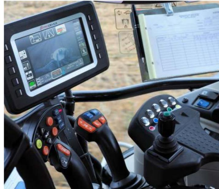
**Agronic In-Control** Le nouveau système de contrôle de camion-citerne HXA II est mis en œuvre avec un joystick à une poignée et un écran tactile.
