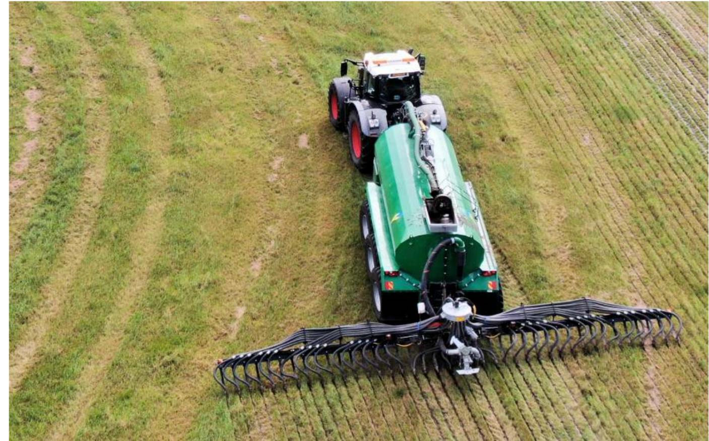
Les chaussures sont suspendues individuellement. Le corps de la rampe peut s'incliner et tourner indépendamment de la tonne à lisier.
