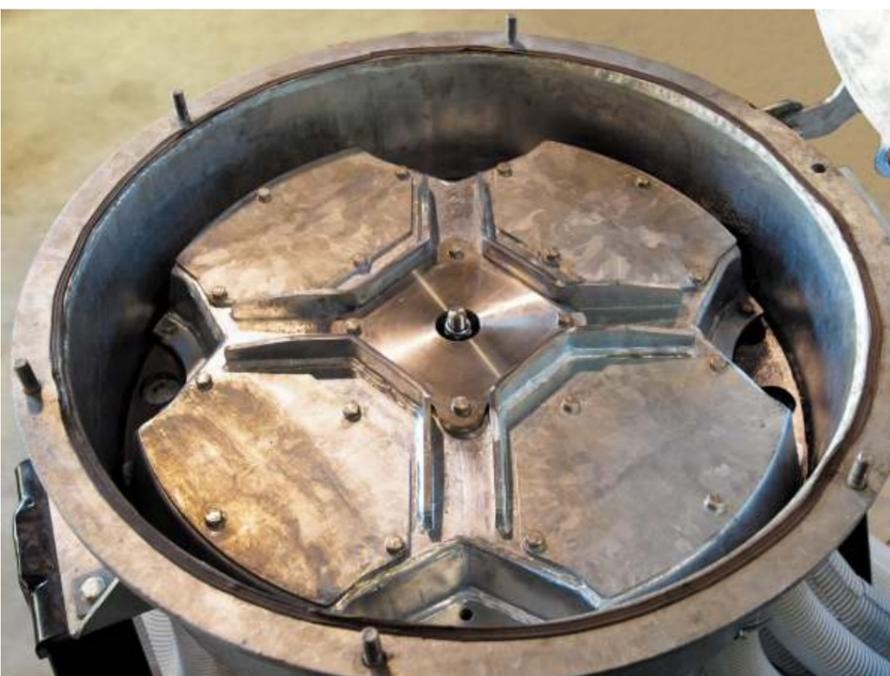
Les couteaux sont des pièces d'usure remplaçables. Le diviseur peut être tourné dans les deux sens et les lames sont réversibles. Vider le piège à pierres est facile grâce à la vanne à tiroir hydraulique standard.
