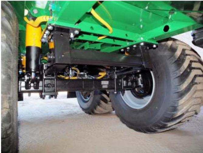
Les tonnes à lisier de la série HXA II ont une direction en crabe et forcée en standard.
