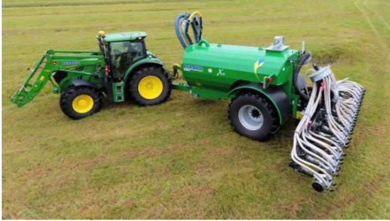
Les tonnes à lisier AGRONIC XS sont légers, agiles et équipés de gros pneus. Ils peuvent être équipés de différentes rampes d'épandage et d'un bras de chargement de pompe.
