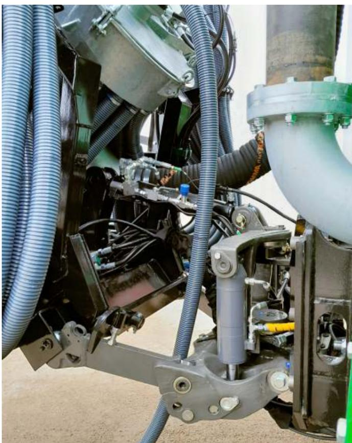
Tringlerie pivotante unique, la rampe peut tourner derrière la cuve à lisier.
