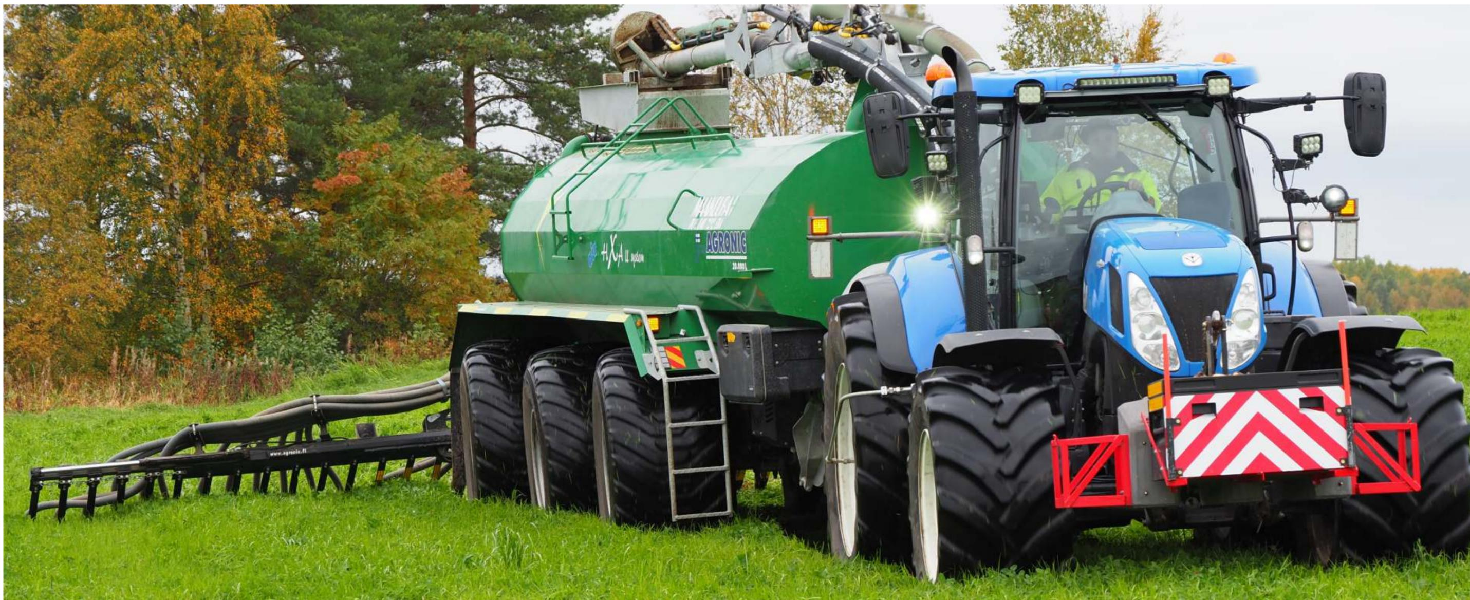
Avec AGRONIC, le système de direction en crabe, la tonne à lisier peut être guidée pour suivre différentes voies, plutôt que directement derrière le tracteur. Le compactage accru du sol et le risque de coincement sont réduits.
