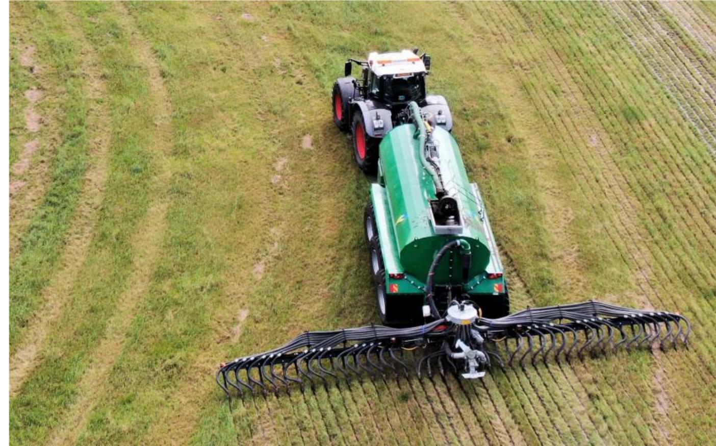
Chaque couteau individuel est équipé d'une suspension. Le châssis de la rampe d'épandage peut être incliné et tourné indépendamment de la tonne à lisier.
