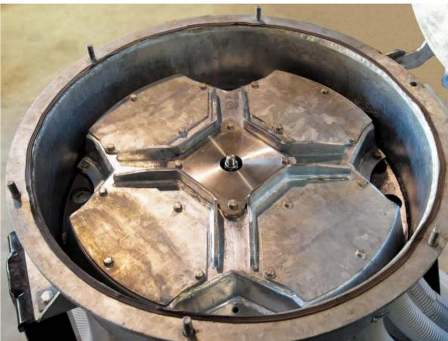
Les lames de coupe sont fabriquées à partir de tôles d'usure HARDOX. Le distributeur peut être tourné dans les deux sens et les couteaux sont réversibles. Le piège à pierres hydraulique standard peut être facilement ouvert depuis la cabine du tracteur.
