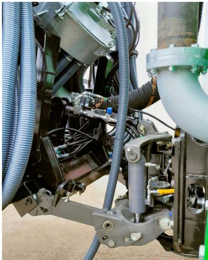
Tringlerie pivotante unique, la rampe peut tourner derrière la cuve à lisier. La rampe/injecteur peut être rentré avec la tonne à lisier en position crabe et courbes au sol.
