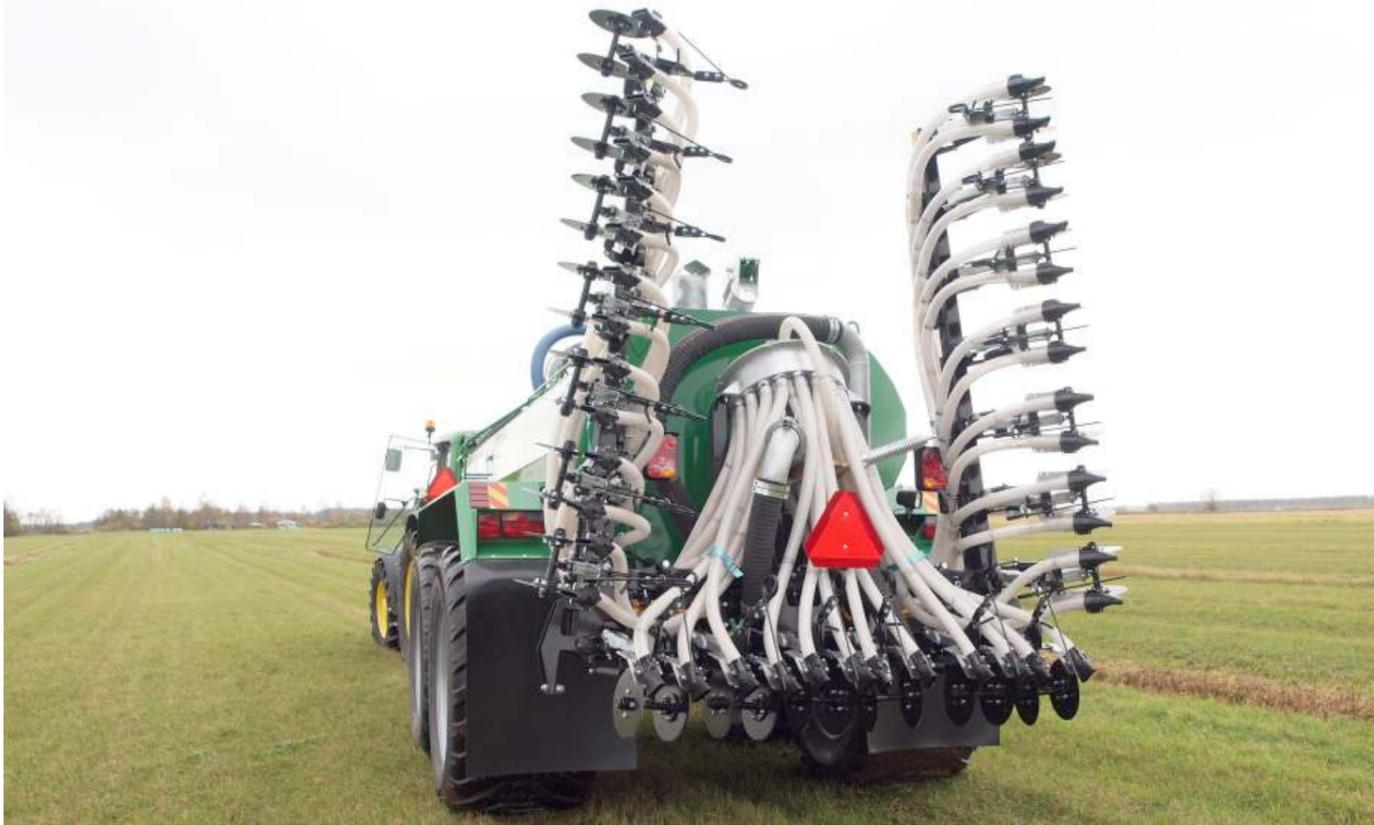
L'injecteur à disque AGRONIC suit de près la surface du sol, le châssis comporte un point d'articulation central, permettant aux sections extérieures de suivre les contours de la surface du sol.
