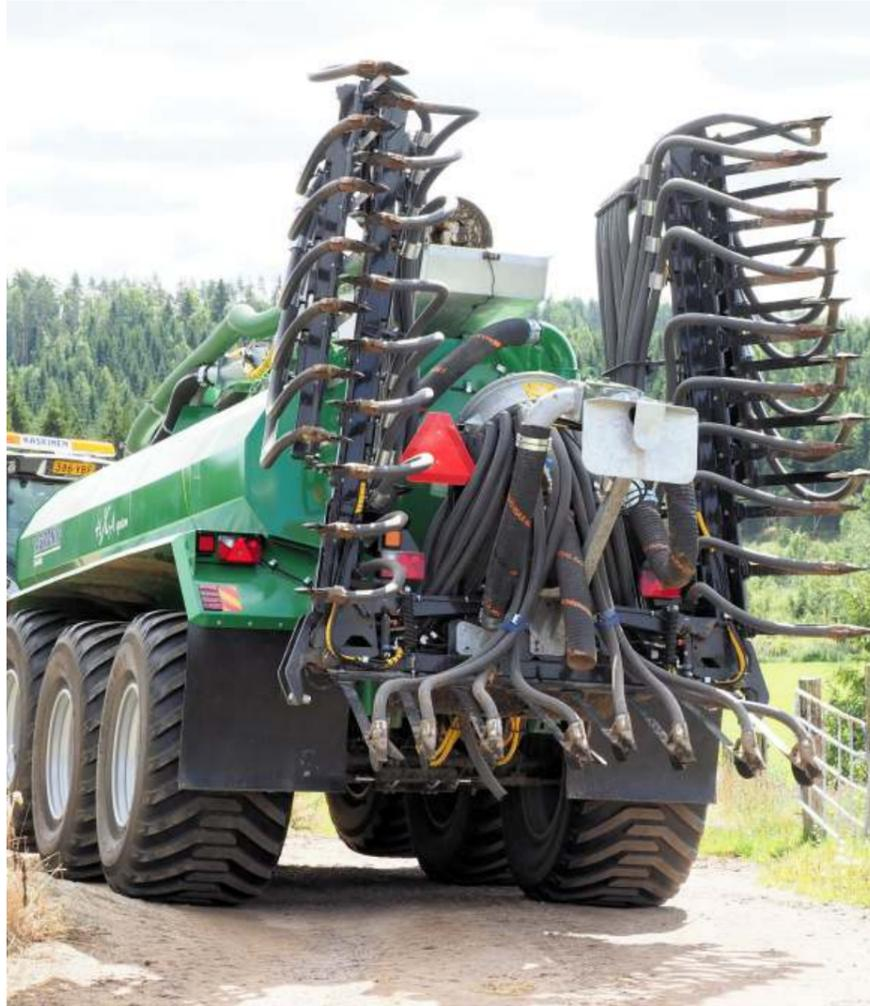
Le pliage pour le transport est automatisé et la rampe est compacte en position de transport.
