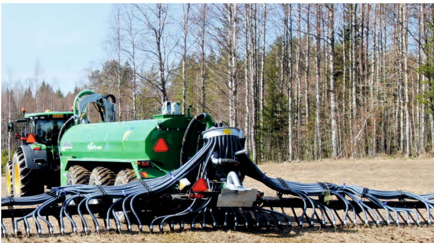
Kuljetusasento on kompakti, siipien taitto on automatisoitu.
