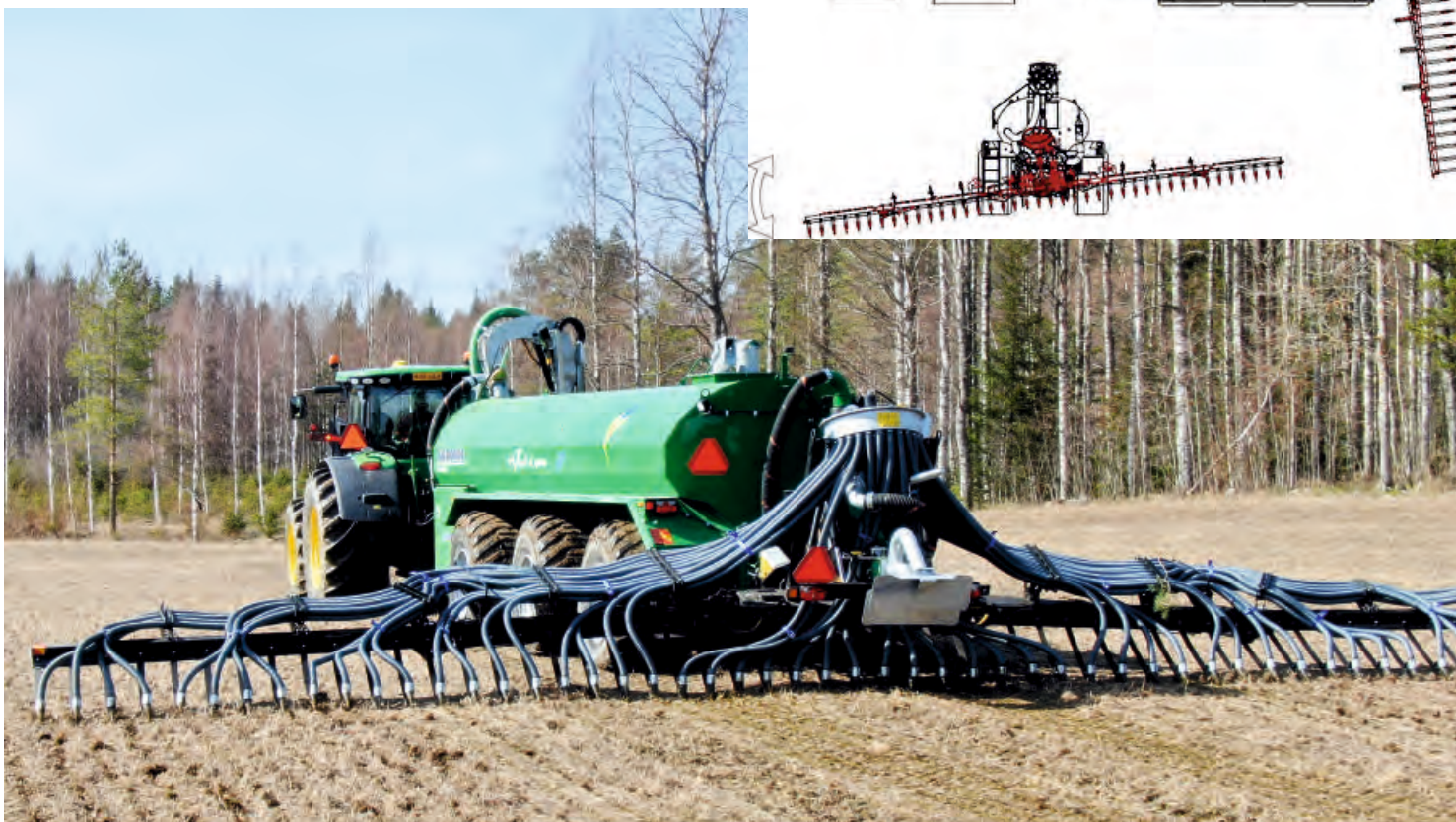
Kuljetusasento on kompakti, siipien taitto on automatisoitu.
