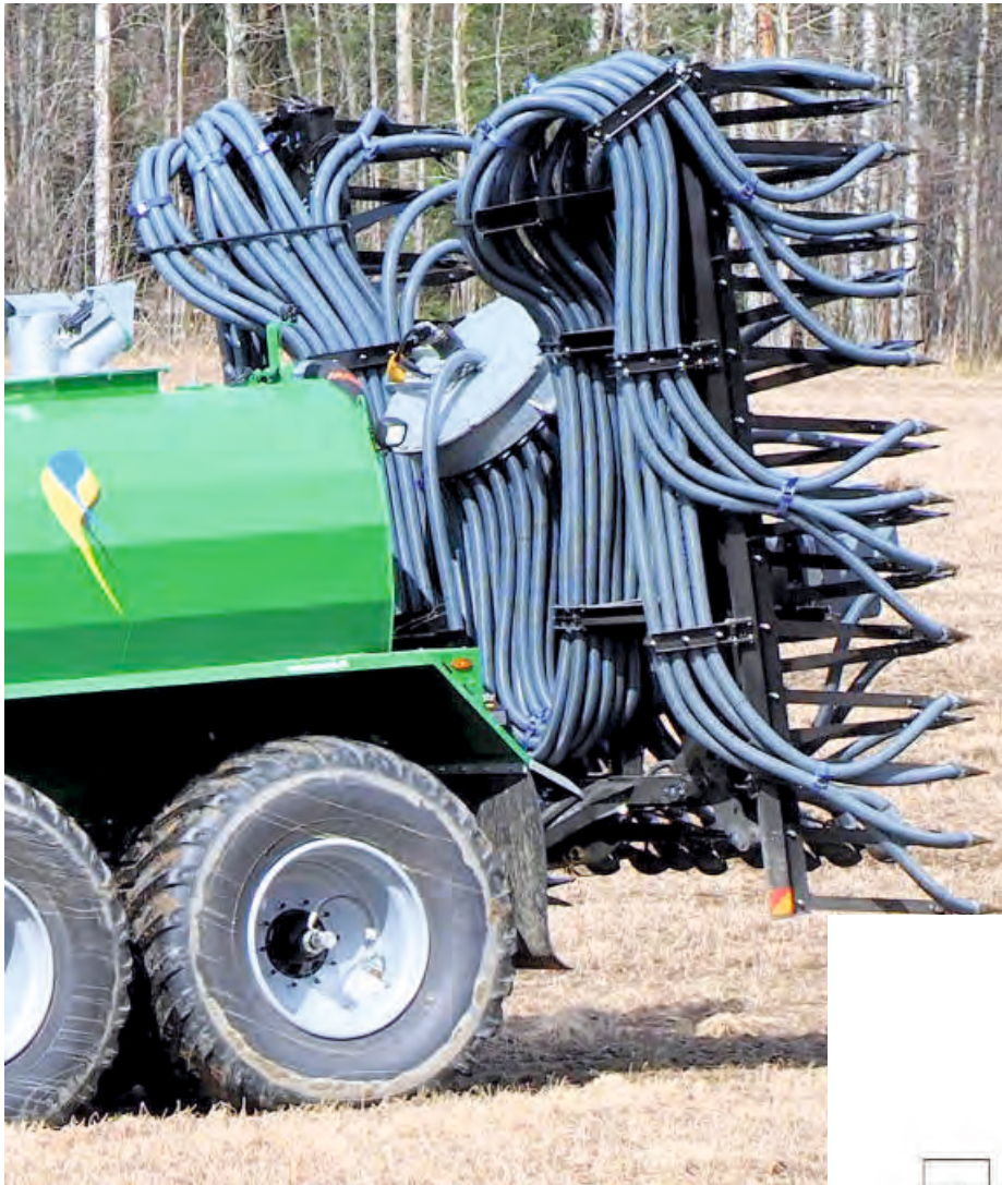
Kuljetusasento on kompakti, siipien taitto on automatisoitu.
