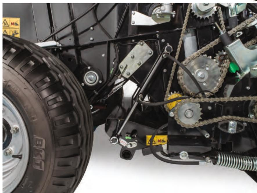
Основание подбирающего механизма открывается за счёт электрогидравлического привода, что позволяет легко удалять засоры. Подпружиненный захват плотно прижимается к земле. Автоматический выключатель захвата для защиты от перегрузки.
