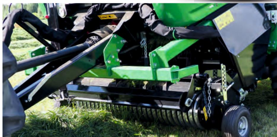
Широкоугольный карданный вал с защитой от перегрузки передаёт мощность на Т-образный угловой редуктор, который распределяет ее на обе стороны машины. Слева - на вальцы, справа - на захват и подбирающий механизм.
