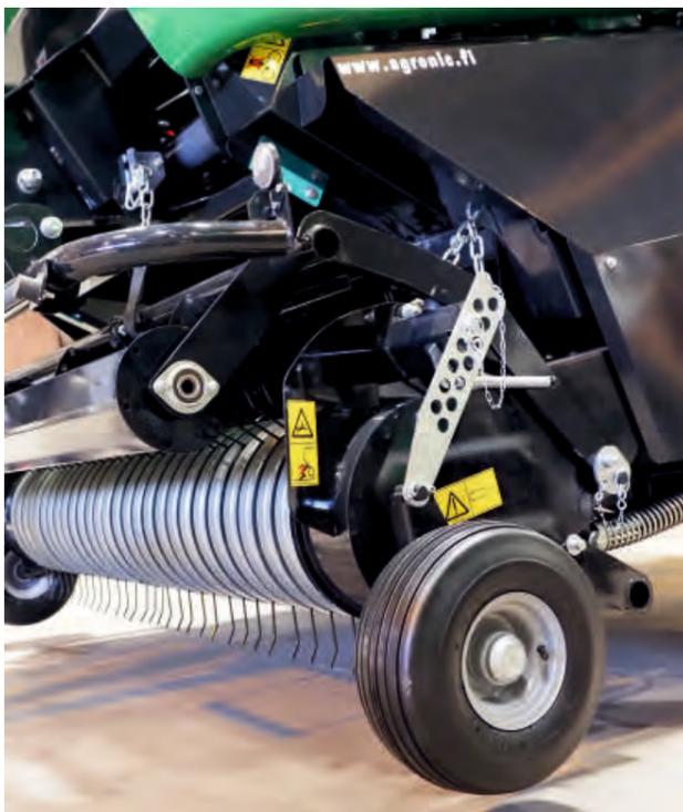
Эффективный захват шириной 210 см. 4 зубчатых лопасти и 112 двойных зубьев. Автоматический выключатель для защиты от перегрузки и прижимной ролик для подбора валков входят в базовую комплектацию.
