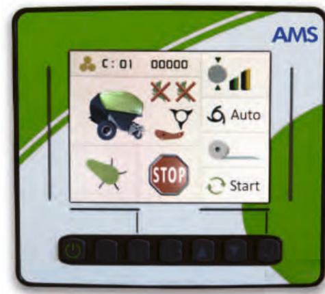
Простая система управления Agronic AMS. Управление количеством ножей и открываемым основанием подбирающего механизма.
