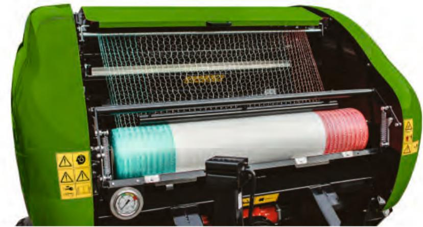
Простое и удобное устройство по обмотки сеткой, ширина сетки 1230-1330 мм.
