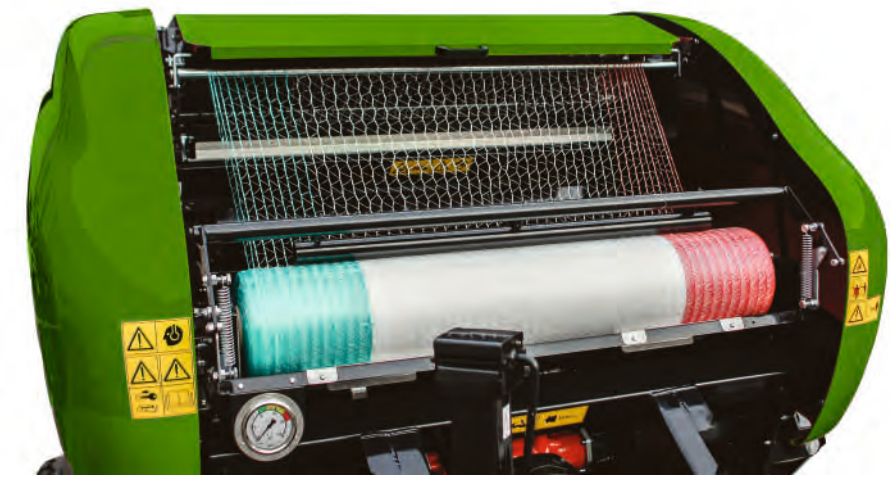
Grand compartiment facilement accessible pour le filet, pouvant accueillir des rouleaux de largeurs de 1230 à 1330 mm (4' et 4' 3"). Indicateur de volume net mécanique et réglage du frein mécanique. Conception fiable et changement facile des rouleaux de filet. Support pour deux rouleaux de filet et une faible hauteur de chargement des rouleaux.
