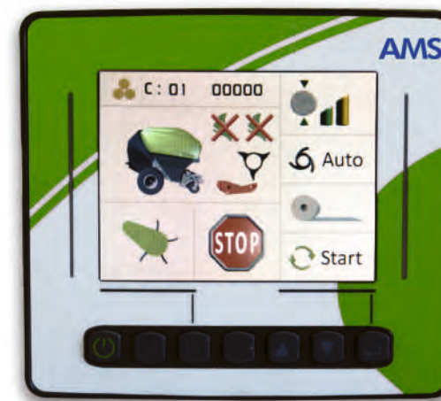
Affichage facile à utiliser pour l'Agronic AMS. Le nombre de couteaux sélectionnés et la montée/descente de la cassette à couteaux. Réglage de la compression de la chambre de compression avec trois réglages préprogrammés. L'achèvement de la balle est indiqué par un écran couleur et un avertissement sonore. Reliure filet automatique ou manuelle. Le compteur de balles, les balles/heure, le nombre total de balles et le nom du champ/client peuvent être stockés en
