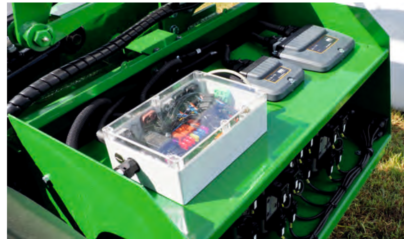
Un système d'application de conservateur PDH-10 conçu en interne et installé en usine.
