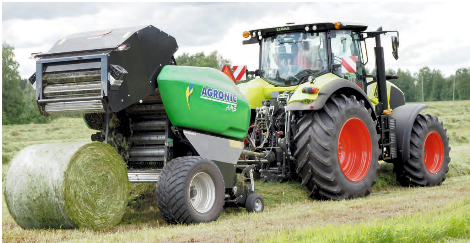
Commande électrohydraulique de la pression de la chambre de compression depuis la cabine du tracteur. Les 18 rouleaux robustes, avec plaques de traction et de guidage, assurent la rotation des balles dans toutes les conditions. Pression de balle optimale avec des exigences de puissance inférieures à la normale.
