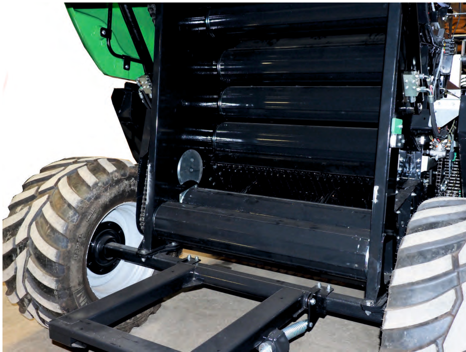
Commande électrohydraulique de la pression de la chambre de compression depuis la cabine du tracteur. Les 18 rouleaux robustes, avec plaques de traction et de guidage, assurent la rotation des balles dans toutes les conditions. Pression de balle optimale avec des exigences de puissance inférieures à la normale.
