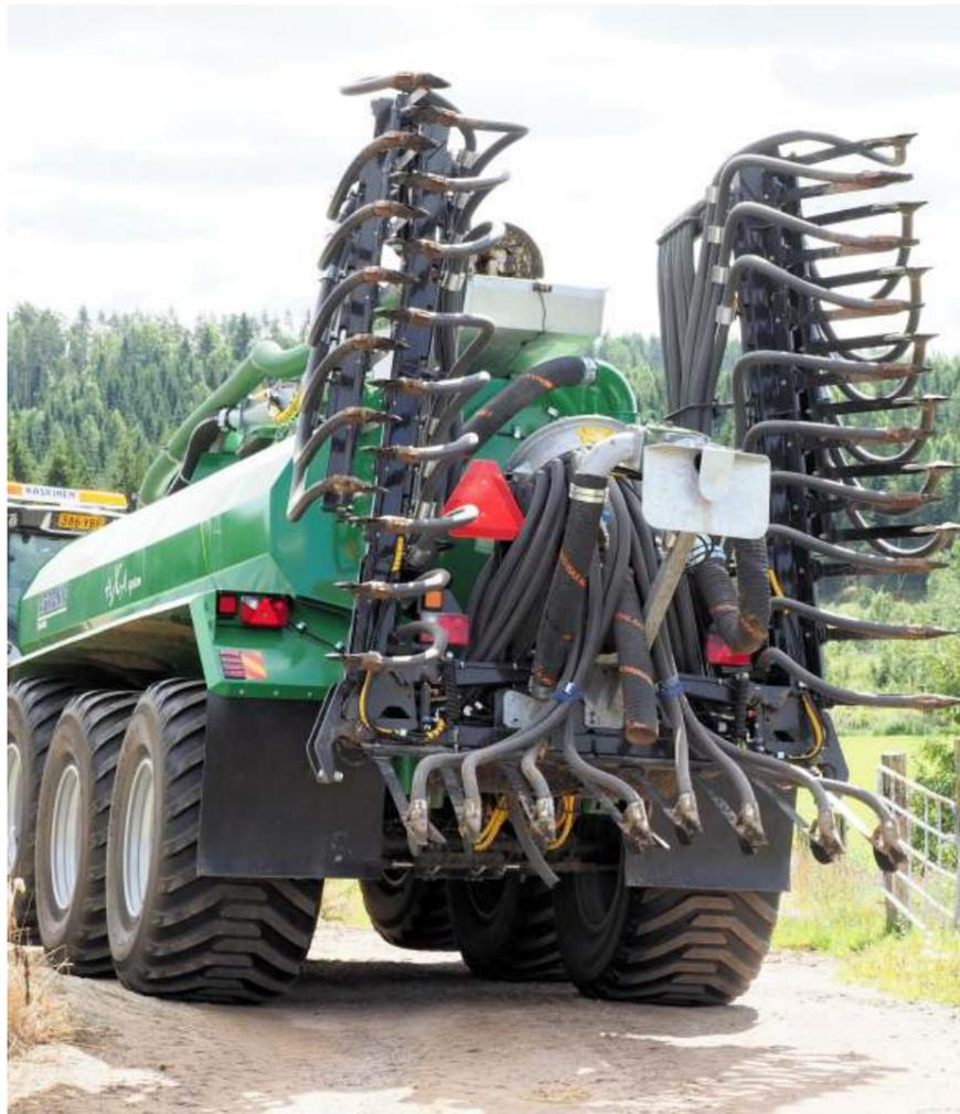
Система компактно складывается для транспортировки, и боковые секции сворачиваются автоматически.
