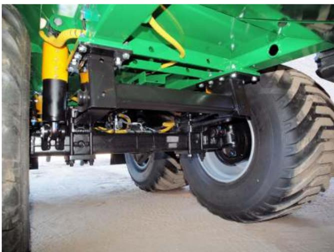
Базовая комплектация цистерн системы HXA II включает принудительное управление и «крабовый» ход.
