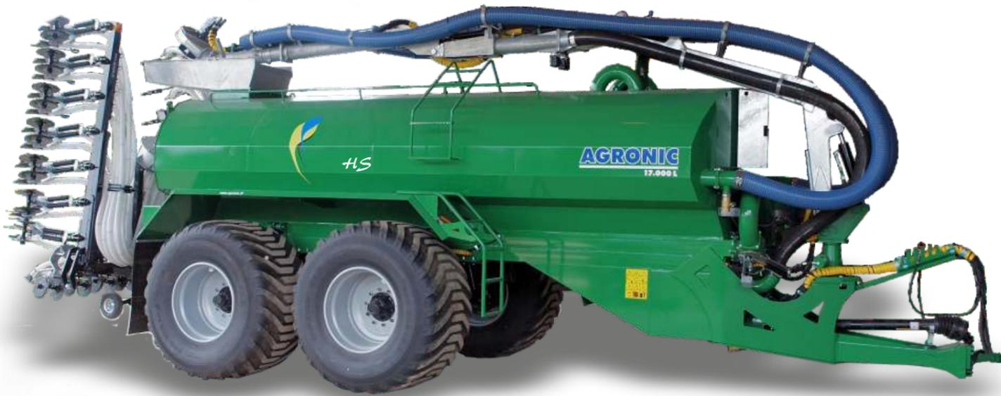
**Серия Agronic HS.** Двух- и трехосные цистерны на гидравлической подвеске с гидравлической системой фрикционного управления и низким центром тяжести.
