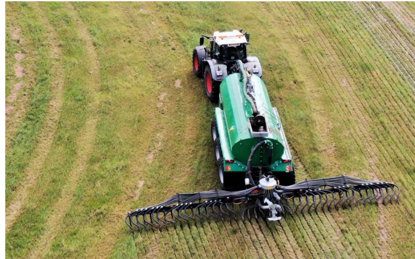
Лезвия оснащены отдельными пружинами. Каркас культиватора наклоняется и поворачивается независимо от цистерны. Повороты и наклоны компенсируются за счет амортизаторов, поэтому культиватор точно следует за профилем поля, обеспечивая качественный результат обработки в любых условиях. - Также на полях с высокой центральной частью и открытыми краями.
