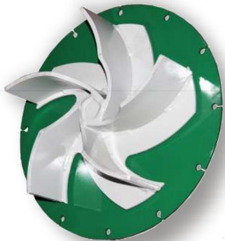
Цистерны Fg, S, HS и Hxa оборудованы мощным сливным насосом на карданном вале с пятью лопастями, оснащенным двумя рядами роликовых подшипников. Рабочее колесо сбалансировано, а подшипники с системой подачи смазки снабжены тройным уплотнением. Ось хромирована для защиты от коррозии и повышения износостойкости.
