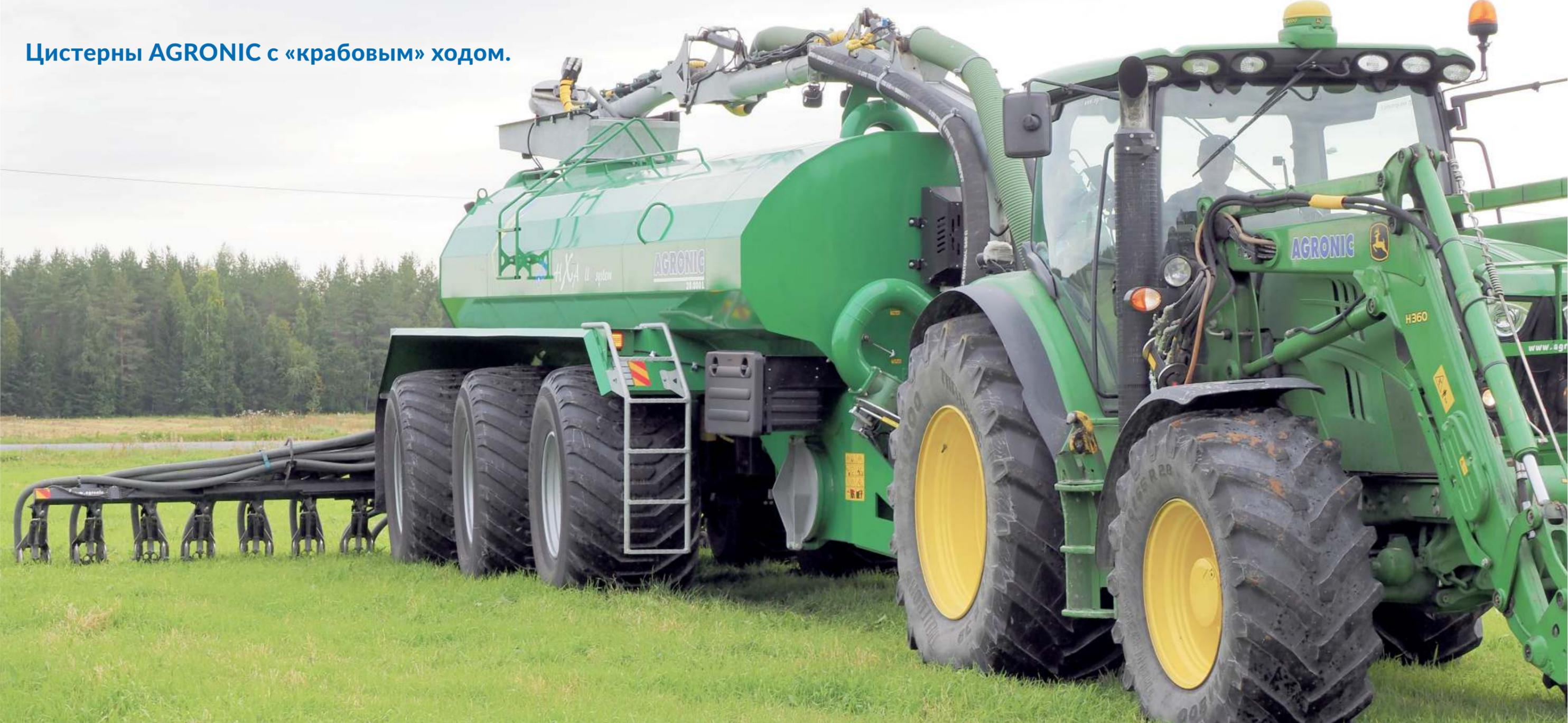
Цистерны **AGRONIC**, оснащенные системой «крабового» хода, могут двигаться по отдельной от трактора траектории. За счет этого уменьшается уплотнение почвы и снижается риск застревания машины.
