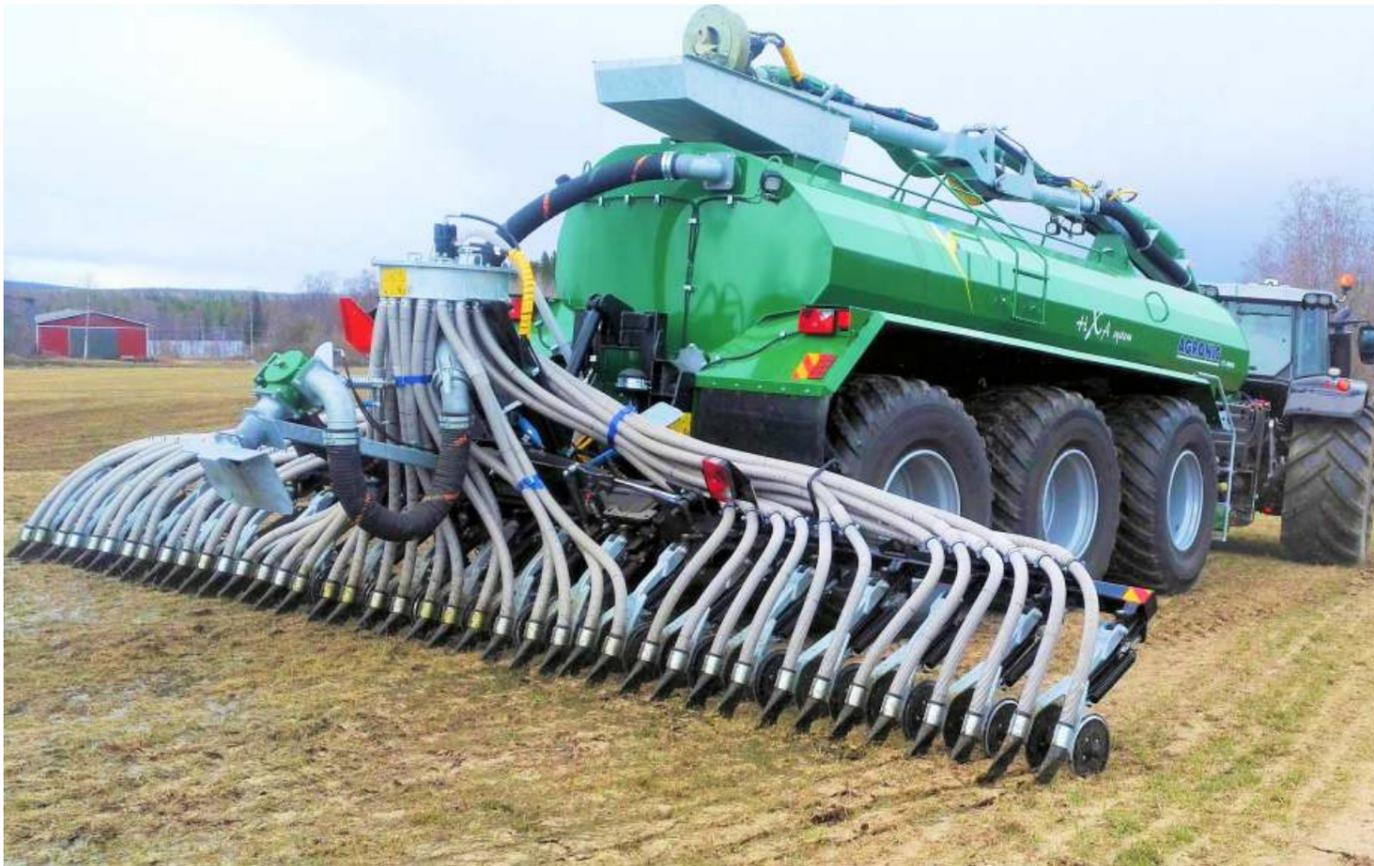
Дисковая система AGRONIC точно повторяет форму грунта. Рама крепится шарнирами к центру цистерны. Боковые секции точно следуют контуру поверхности. Рабочий диапазон лемехов составляет 0,5 метра.
