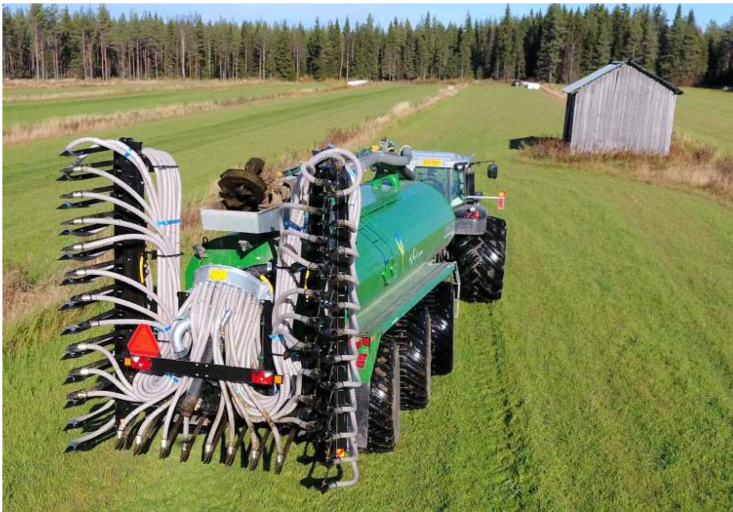
Компактное складывание для транспортировки, секции сворачиваются автоматически
