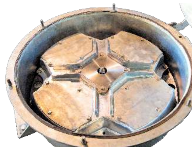
Измельчительная головка направляет поток в четырех направлениях.
