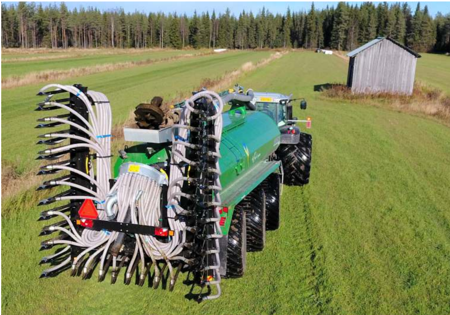
Kuljetusasento on kompakti, siipien taitto on automatisoitu.
