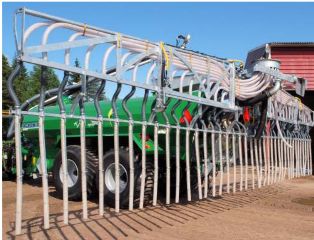
Kuljetusasento on kompakti, siipien taitto on automatisoitu.
