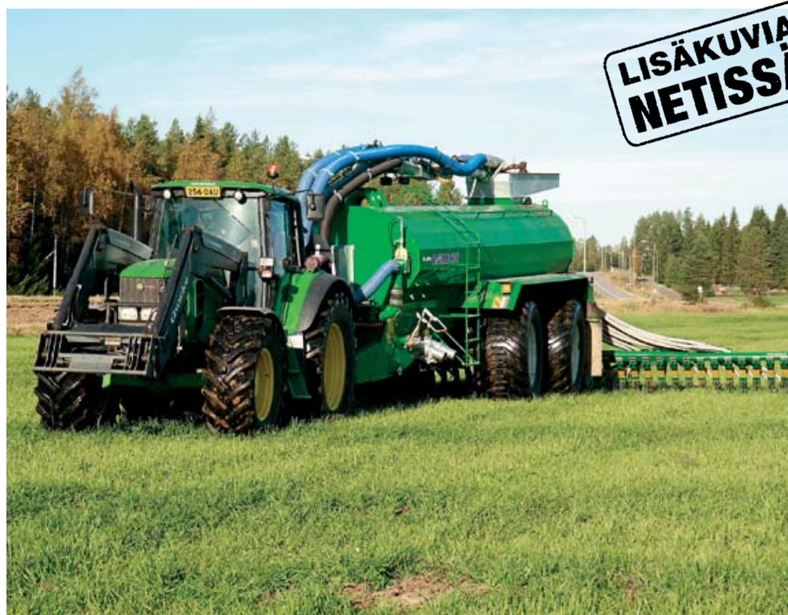
↑ Kärriin telin takimmainen pyörä kulkee etummaisen renkaan keskilinjaa. Näin kärriin telin jättämä jälki on 1275 millia leveä.
