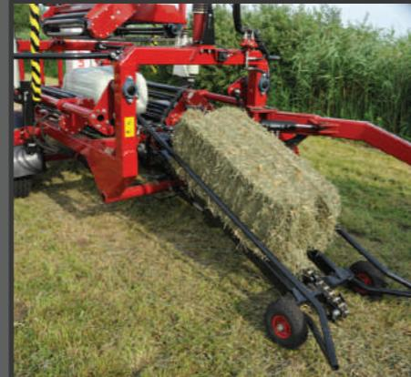
// Ballen Aufnahmesystem seitlich und gerade hinten der Schlepper zu verwenden. Maschine lädt automatisch eine neue Balle während das Abladen von der gewickelten Balle.
