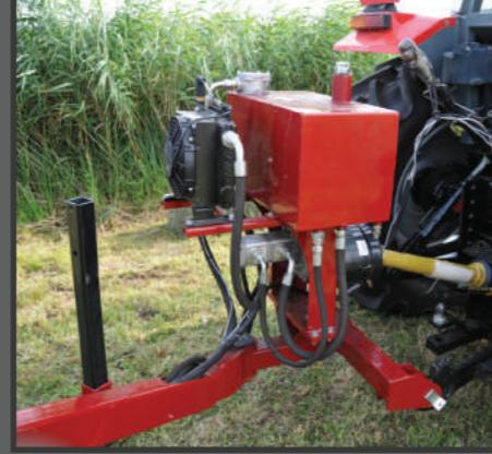
// Eigenes Hydrauliksystem ausgerüstet mit Doppel-Ölpumpe und Ölkühler. Funktionieren der Maschine ist nicht abhängig von der verwendeten Schlepper.
