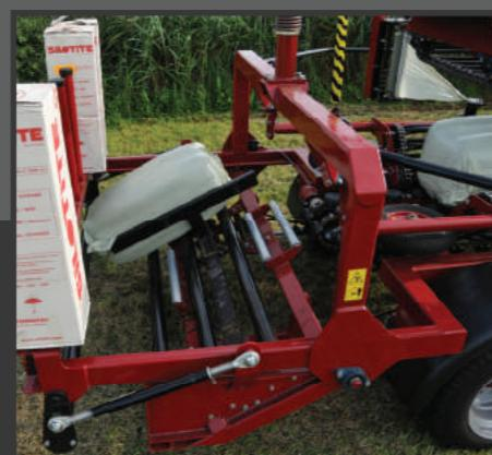
// Ballensammler einstellbar für 1,2, oder 3 Ballen ab zu laden. Durch das Sammeln können der Ballen effizient aus dem Land entfernt werden.
